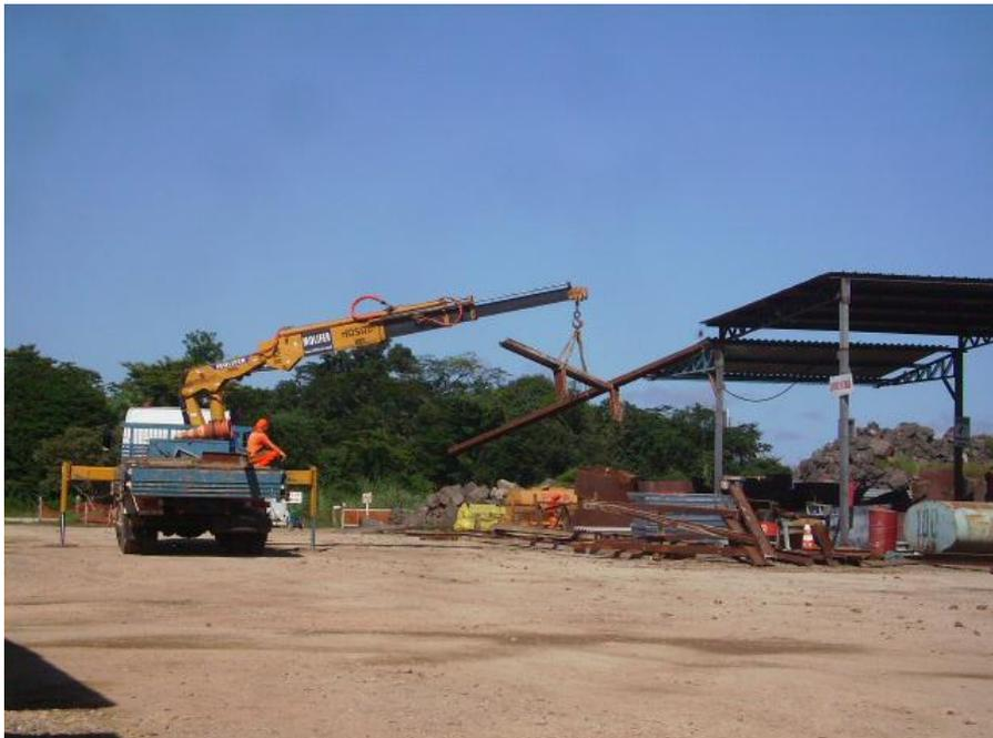
FIGURA 15 – CAMINHÃO COM GUINCHO ACOPLADO FAZENDO O TRANSPORTE DE PEÇAS
