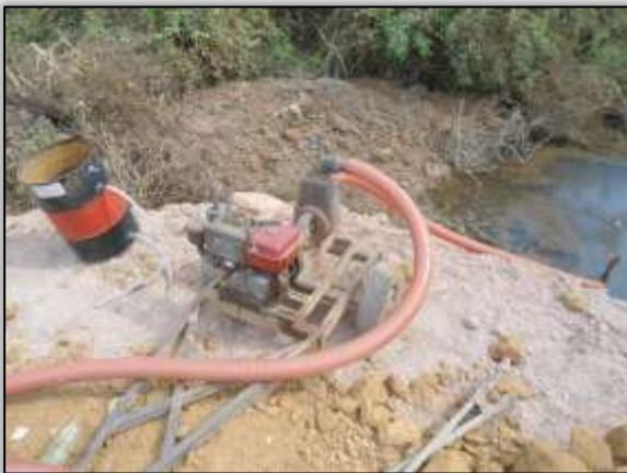
Foto 74 – Bomba para captação de água sem proteção (Antes). Lado
