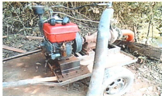
Foto 02 - Ausência de caixa de contenção para o óleo do motor.
