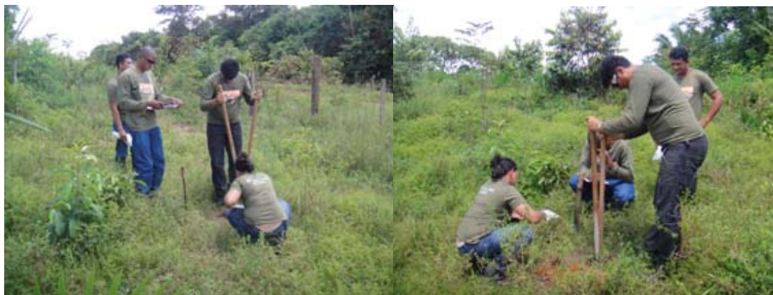
Figura 36 - Abertura de tradagens para verificação de material em sub-superfície
