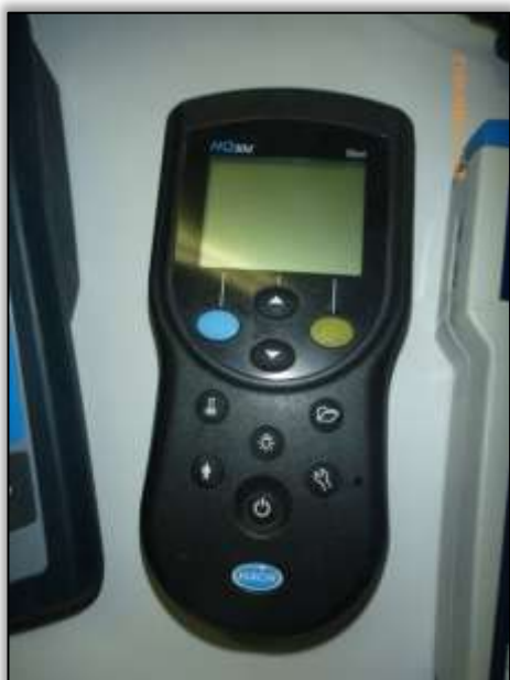
Foto 1270 - Aparelho usado para determinação dos parâmetros – HQ30d (HACH) – OD, DBO, Temperatura, pH e Sólidos Totais Dissolvidos
