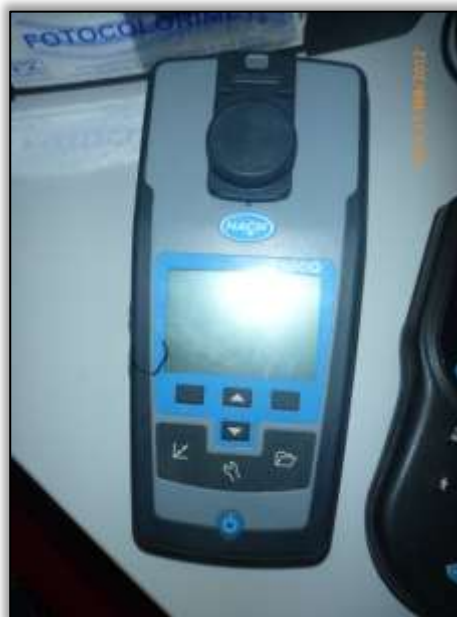
Foto 1271 - Aparelho usado para determinação dos parâmetros 2100Q (HACH) - Turbidez
