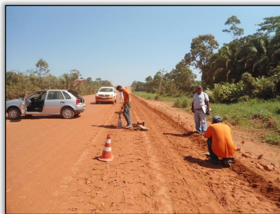
Foto 295 - Análise de compactação. Estaca 2321 até 2324. S 03. 25758° W 051. 46817° 01/08/2012
