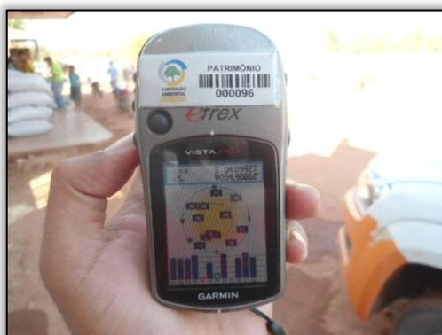
Foto 30 – GPS GARMIN utilizado para o georreferenciamento dos pontos de amostragem.
