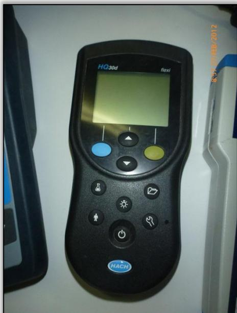
Foto 33 – dispositivo de leitura multiparâmetros HQ30d (HACH) usado para determinação dos parâmetros — OD, Temperatura, pH e Sólidos Totais Dissolvidos
