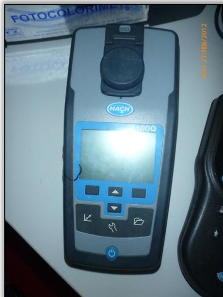
Foto 34 - Aparelho 2100Q (HACH) usado para determinação dos parâmetros - Turbidez
