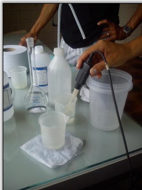
Foto 36 – Calibração e manutenção das sondas
