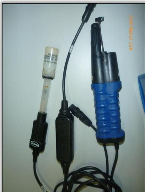
Foto 35 - Sondas usadas para determinação dos parâmetros no dispositivo de leitura multiparâmetros HQ30d (HACH)
