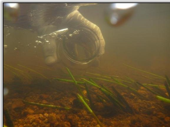
Foto 45 – Mergulho do frasco para coleta (segundo a metodologia do trabalho de coleta – 15 a 30 cm de profundidade)
