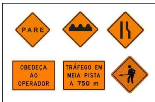
Figura 7 – Placas de sinalização para obras. Fonte: DNIT – IPR 238.
