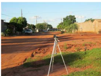
Foto 4.1.g: Mediação de ruído em residências próximas à BR-163/MS
