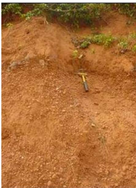
**Figura 6.1.11 - Exposição de um conglomerado composto por seixos de até 10 cm de diâmetro com contato erosivo com um arenito vermelho.**
