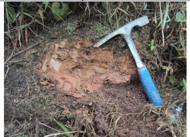
**Foto 8 - Detalhe do solo de alteração de porção mais xistosa do migmatito. Solo de alteração marrom arroxado constituído por silte arenoso-argiloso, micáceo.**
