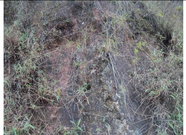
**Foto 6 – Detalhe de gnaiss alterado aflorando na área de empréstimo. A rocha encontra-se fraturada e com foliação subvertical.**
