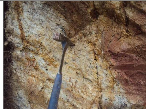
**Foto 7 - Detalhe do solo de alteração de gnaiss na área de empréstimo. Trata-se de silte arenoso a pouco argiloso, micáceo e com caulim.**
