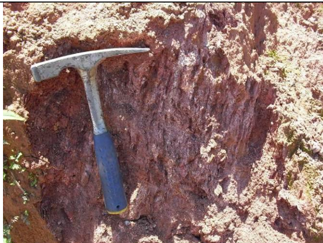
Foto 7 – Solo de alteração de micaxisto com estrutura reliquia subvertical (silte arenoso pouco argiloso, micáceo, roxo variegado). Estaca 17851.
