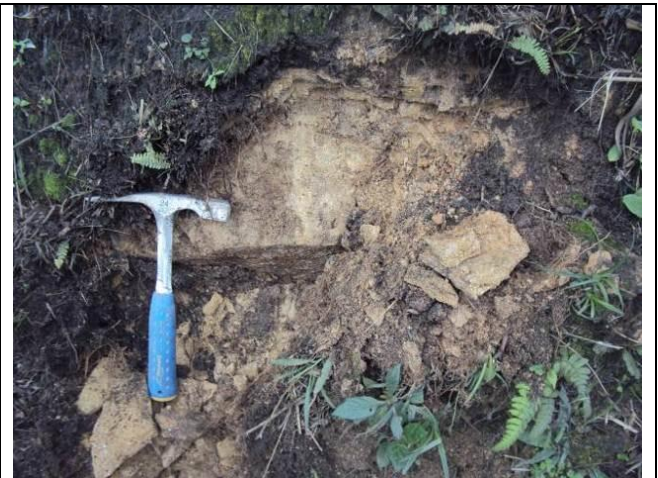
Foto 6 – Detalhe de blocos angulosos de gnaiss e migmatito sob camada centimétrica de solo vegetal. Estaca 17377.
