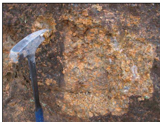
Foto 5.1-46 Outro exemplo de neossolo lítico. Textura granítica evidente na matriz de solo.
