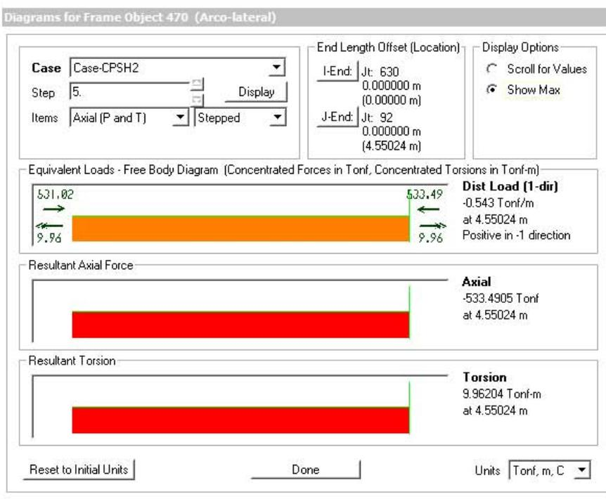
Figura 46 - Elemento do arco lateral 470 -Esforços Axiais
