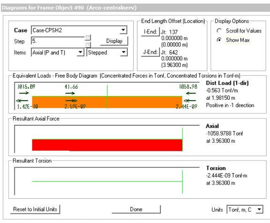
Figura 36 - Elemento do arco central 490 - Esforços Axiais
