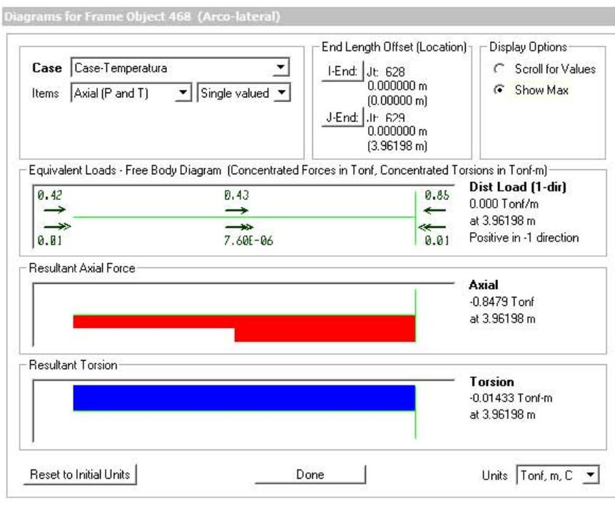
Figura 166 - Elemento do arco lateral 468 - Esforços Axiais
