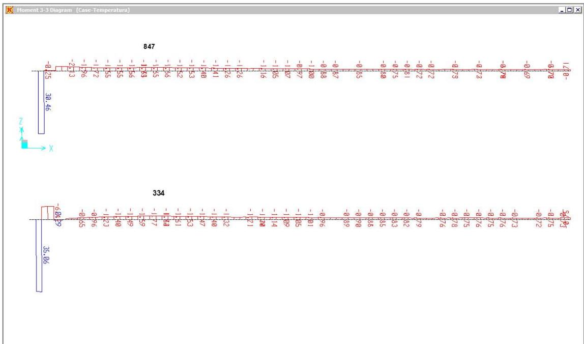
Figura 180 - 1/2 Longarinas principais laterais - 1/2 seção - barras 847 e 334 - Momentos Fletores
