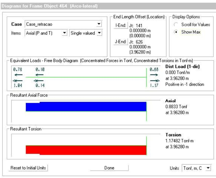
Figura 229 - Elemento do arco lateral 464 - Esforços Axiais
