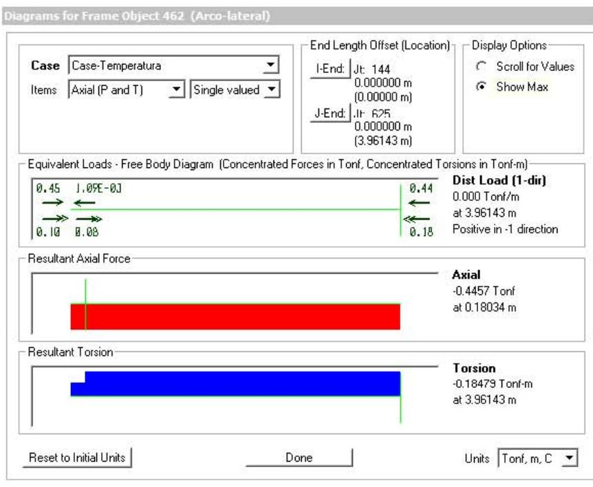
Figura 172 - Elemento do arco lateral 462 - Esforços Axiais
