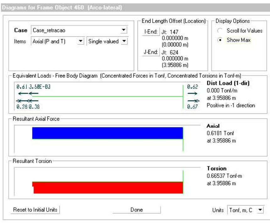
Figura 233 - Elemento do arco lateral 460 - Esforços Axiais
