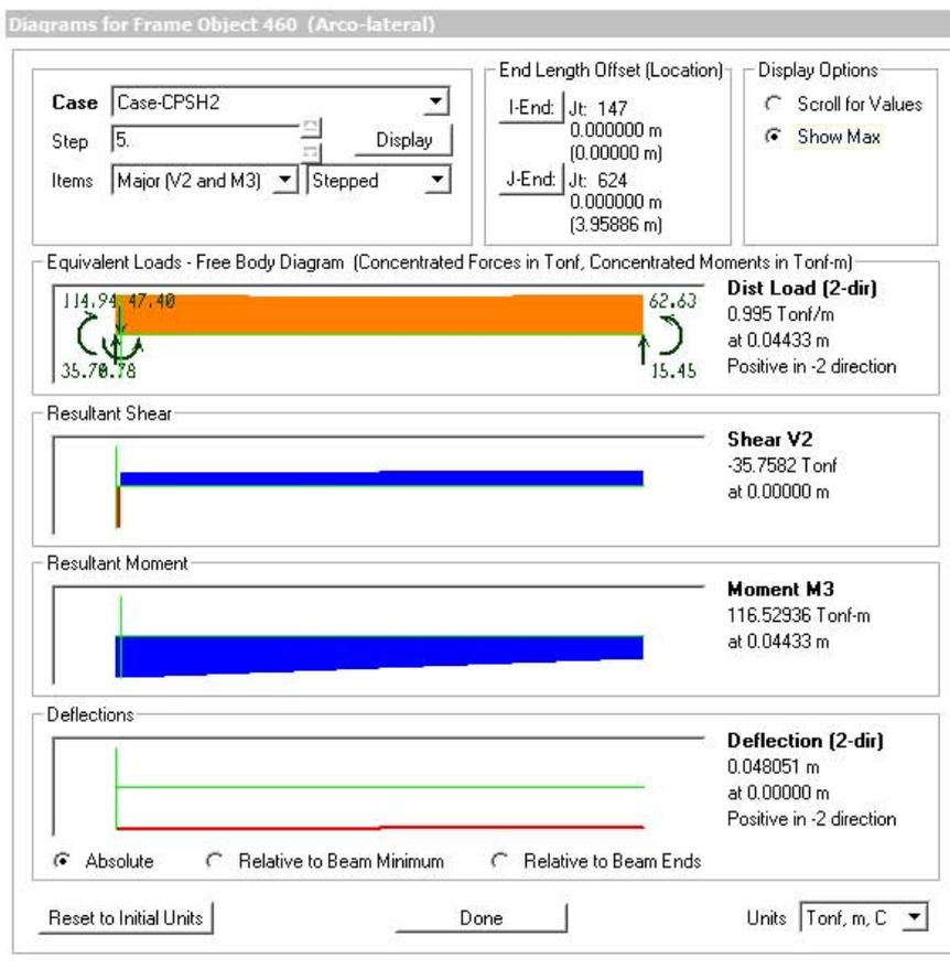
Figura 55 - Elemento do arco lateral 460 - Momentos fletores
