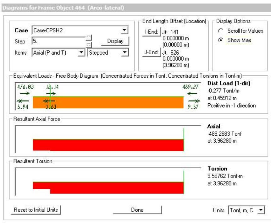
Figura 52 - Elemento do arco lateral 464 - Esforços Axiais
