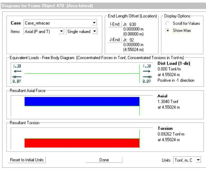
Figura 223 - Elemento do arco lateral 470 - Esforços Axiais
