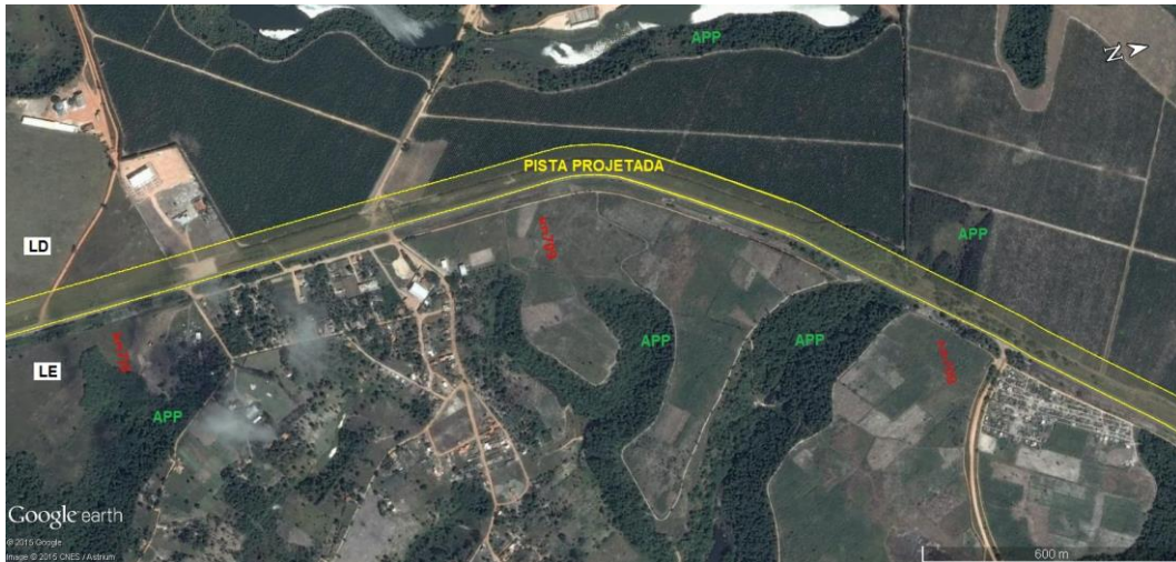
FIGURA 10. 5 – POSICIONAMENTO DA SEGUNDA PISTA, EVITANDO-SE INTERFERENCIAS COM NÚCLEOS URBANOS E APP'S. IMAGEM OBTIDA DO GOOGLE EARTH
