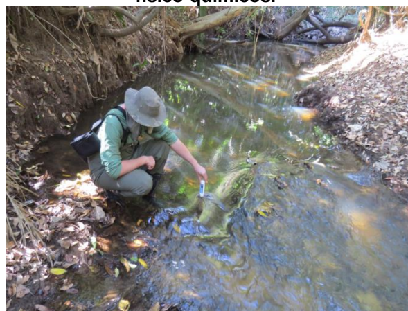
FIGURA 5.146 - Mensuração de parâmetros físico-químicos.
