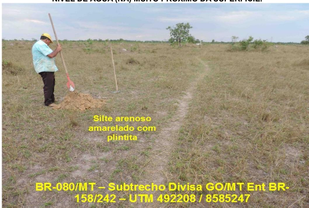
**FIGURA 5.64: CARACTERIZAÇÃO DO PERFIL DE SOLO OBSERVADO NO FURO 01.**
