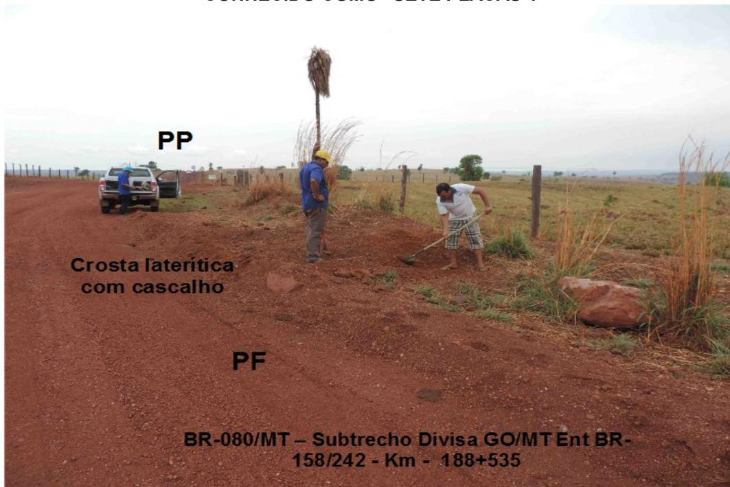
**FIGURA 5.84: CARACTERIZAÇÃO DO PERFIL DE SOLO OBSERVADO NA COLETA 11.**
