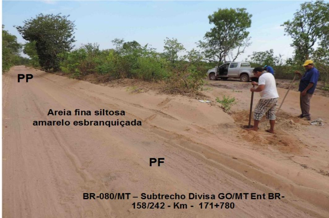
**FIGURA 5.80: CARACTERIZAÇÃO DO PERFIL DE SOLO OBSERVADO NO FURO 09.**
