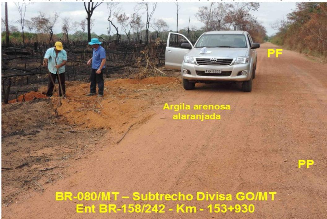
**FIGURA 5.76: CARACTERIZAÇÃO DO PERFIL DE SOLO OBSERVADO NO FURO 07.**
