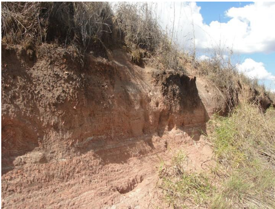
Foto - 140 – Neossolo Quartzarênico, onde é possível observar o protolito a profundidade superior a 50cm.
