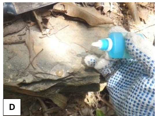
Figura 1- A) Um dos veículos utilizados no deslocamento das equipes. B) Serviço de espeleotopografia. C) Espeleólogo em trabalho de prospecção a pé. D) Utilização de solução de ácido clorídrico para identificação de rochas carbonáticas.
