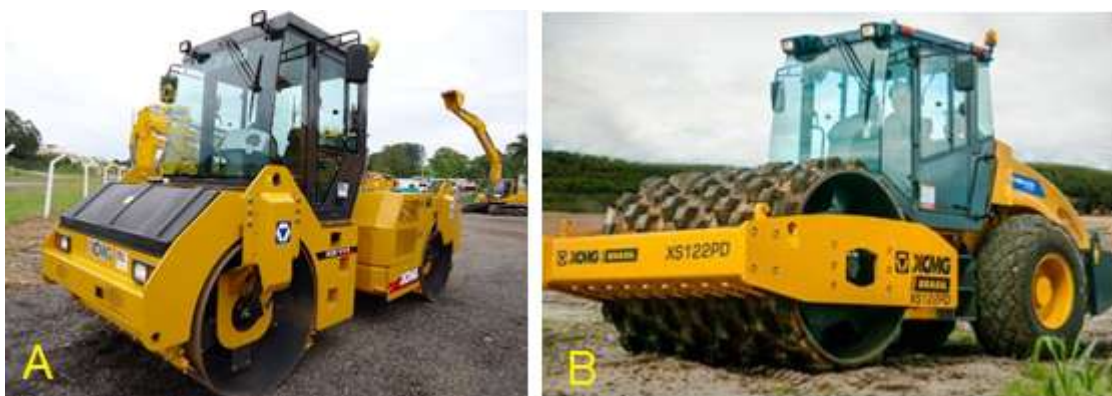
Figura 4 - A – Rolo compactador vibratório liso e B – Rolo compactador vibratório “pé-de-carneiro”.
