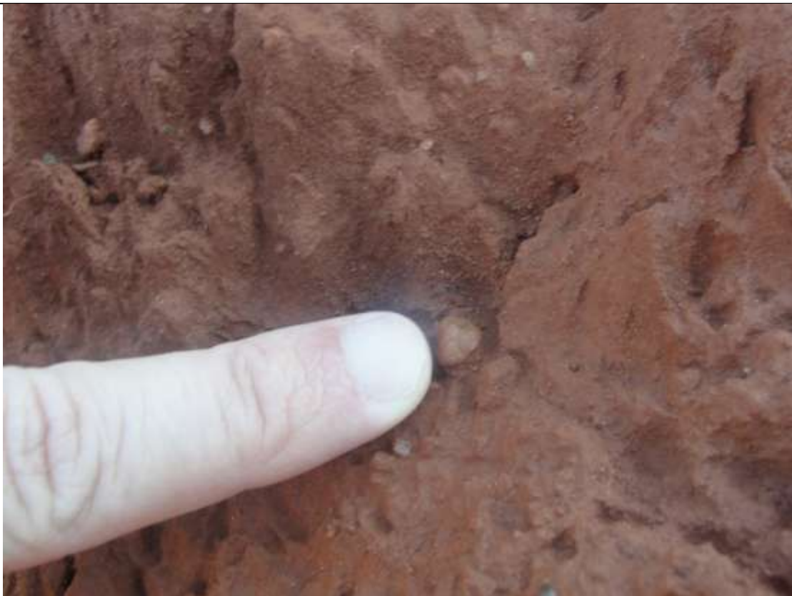
Foto 63– Nitossolo com mineral remanescente após lixiviação intensa. Município de Monte Alegre de Minas.
