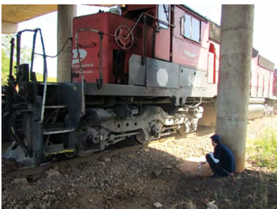
Realização da medição de vibração em base de pilar de um viaduto sob linha de trem.
