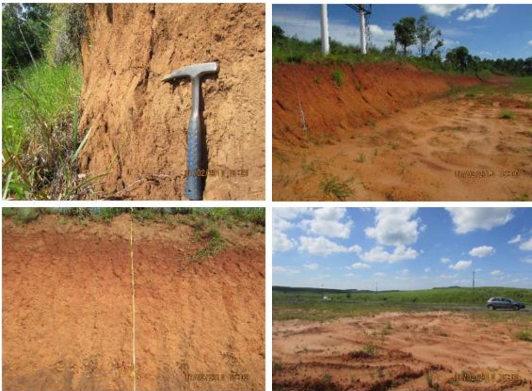
Figura 59 - Solo arenoso derivado de rochas da Fm. Piramboia. Observa-se estrutura de empastilhamento típico
