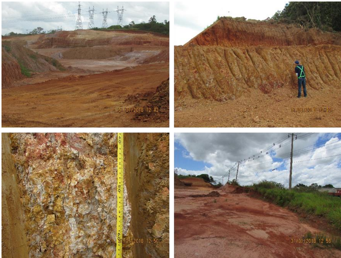
Figura 80 – Perfil de Argissolo Vermelho-Amarelo distrófico de coloração variegada ao longo de via de acesso a BR-386. Solo com espessura variada de até 4 metros, erodível.
