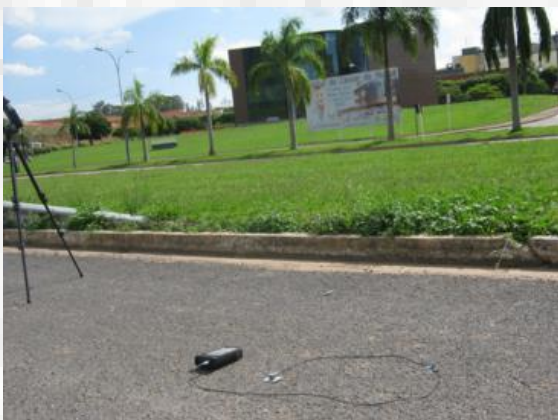
Equipamento para medição de vibrações em frente ao hospital de Câncer de Muriaé/MG. Foto: Equipe STE
