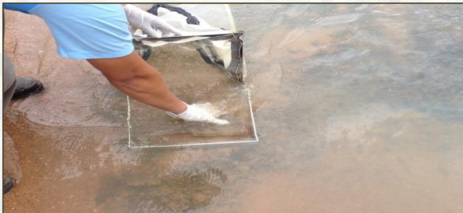
Utilização de peneira para estudo de moluscos e larvas, na amostragem chamada de macrofauna bentônica (Surber) - estação no rio São João. Foto: Equipe STE.
