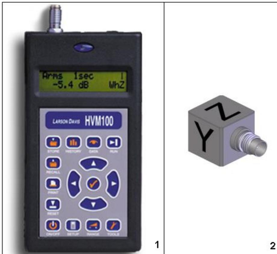
Figura 4 - Equipamentos de Medição de Vibração. 1- HVM-100 e 2- 3093M8
