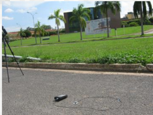
Equipamento para medição de vibrações em frente ao hospital de Câncer de Muriaé/MG.
