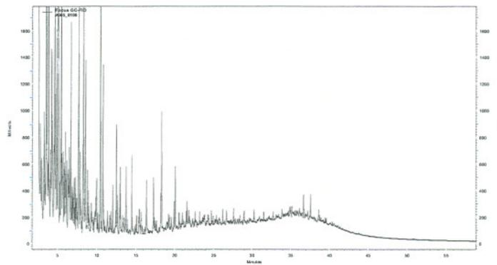
Cromatograma da análise de TPH da amostra de água produzida - Plataforma PNA-1
