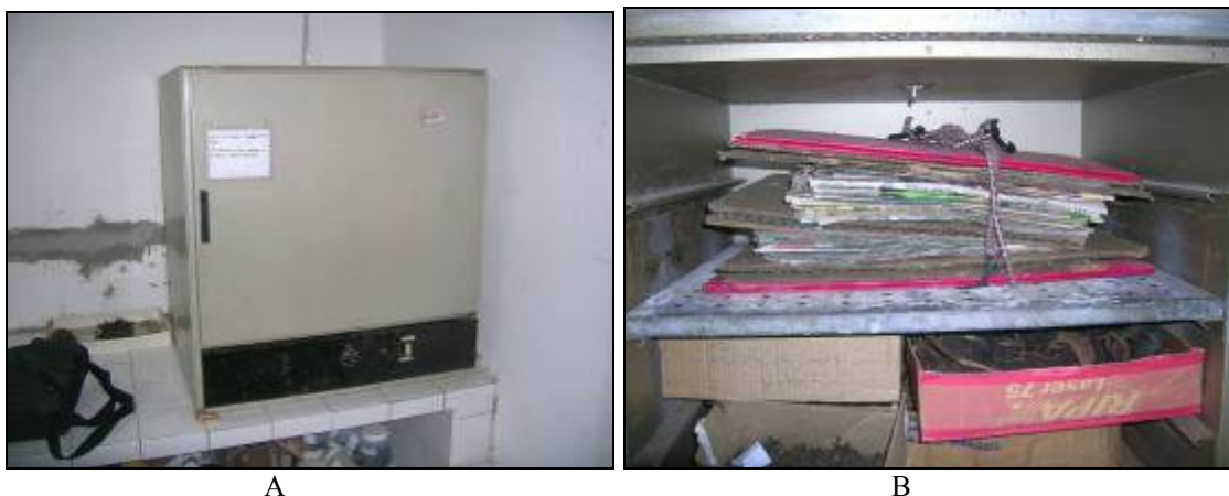
Figura 12. Estufa de secagem de plantas (A) e prensa com plantas (B) para herborização em secagem a 60°C.
