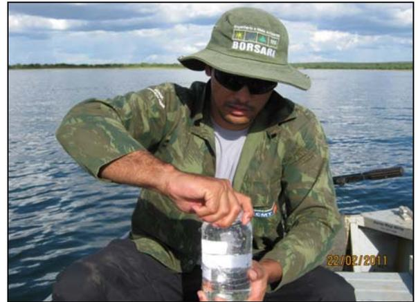
Foto 4.22.24. Acondicionamento de amostra para análise de óleos e graxas no reservatório Itaparica, ponto Q54 (fev/11).
