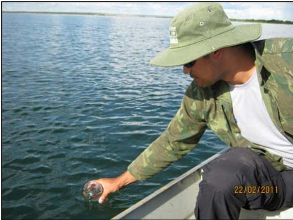
Foto 4.22.23. Coleta de amostra para análise de óleos e graxas no reservatório Itaparica, ponto Q03 (fev/11).
