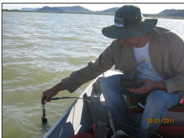
Foto 4.22.14. Coleta dos dados com a sonda Horiba no reservatório Sobradinho, ponto Q01 (jan/11).
