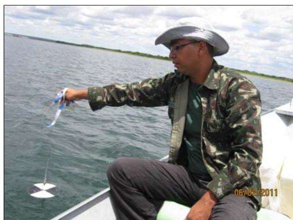
Foto 4.22.15. Uso do Disco de Secchi para medição de transparência no lago de Itaparica, ponto Q54 (fev/11).
