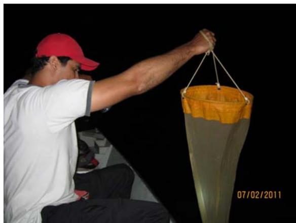
Foto 4.22.20.Coleta de zooplâncton com a rede de arraste no açude Poço da Cruz, ponto Q81 - Coleta Nictemeral (fev/11).
