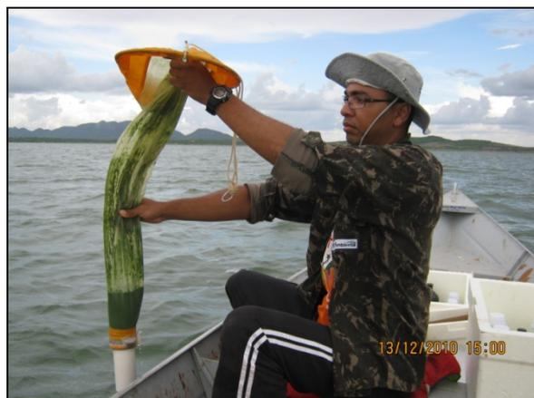
Foto 4.22.8. Uso da rede de arrasto para coleta de amostra de zooplâncton no açude Orós, ponto Q24 (dez/10).
