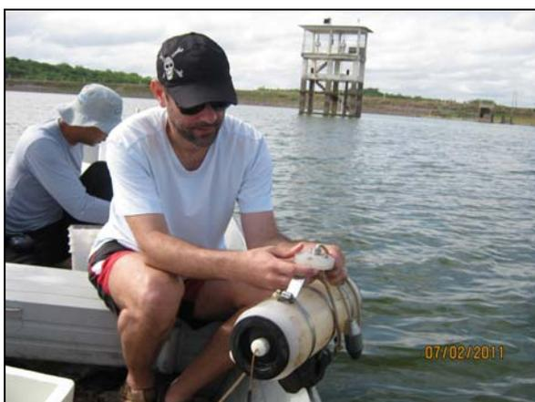
Foto 4.22.17. Coleta de fundo com a garrafa de Van Dorn no açude Poço da Cruz, ponto Q81 - Coleta Nicteveral (fev/11).
