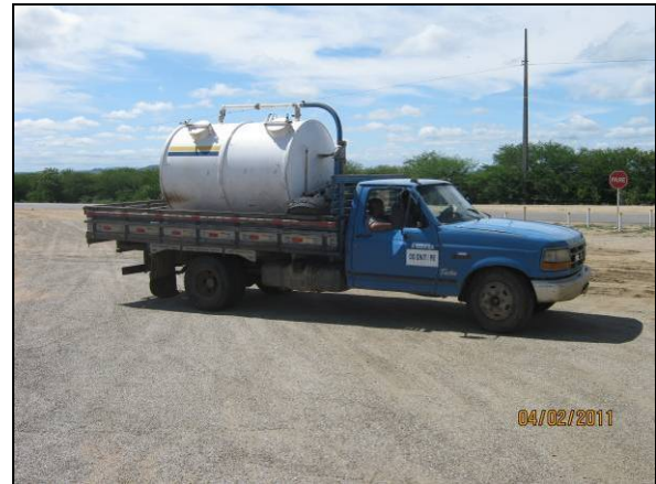
Foto 4.2.760. Coleta e transporte dos efluentes gerados nos banheiros químicos do canteiro de Sertânia - PE (fev/11).
