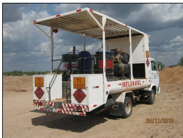
Foto 4.2.459. Melosa para lubrificação e abastecimento de máquinas no trecho III do WBS 2204 (nov/10).
