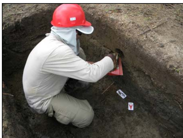
Foto 4.6.21. Coleta de Amostras de Sedimento na Sondagem.
