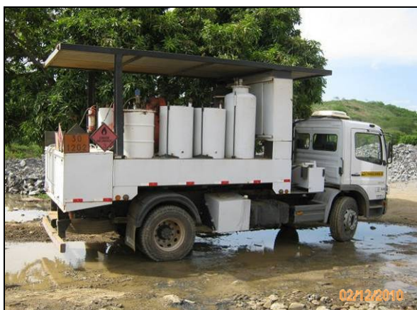
Foto 4.2.895. Caminhão comboio na frente de serviço da janela do túnel Cuncas I (dez/10).
