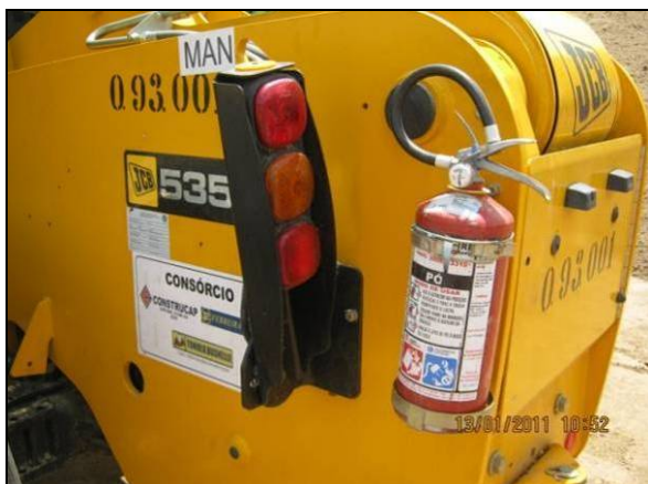
Foto 4.2.841. Extintor de incêndio acoplado em máquina pesada na janela do túnel Cuncas I (jan/11).
