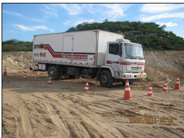
Foto 4.2.175. Paiol móvel sinalizado e devidamente equipado para o transporte de explosivos, WBS 1218 (jan/11).
