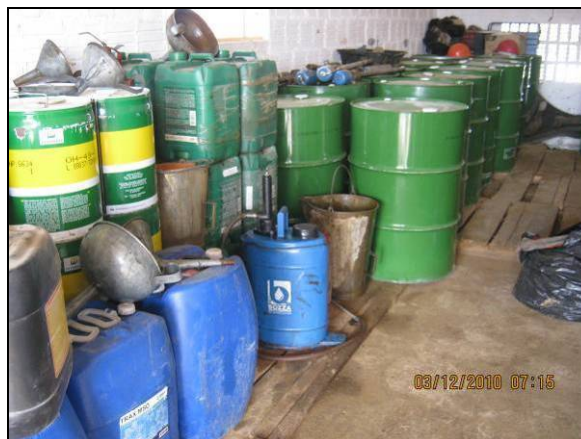
Foto 4.2.192. Armazenamento dos tambores de óleos lubrificantes em local coberto e com piso impermeabilizado (dez/10).
