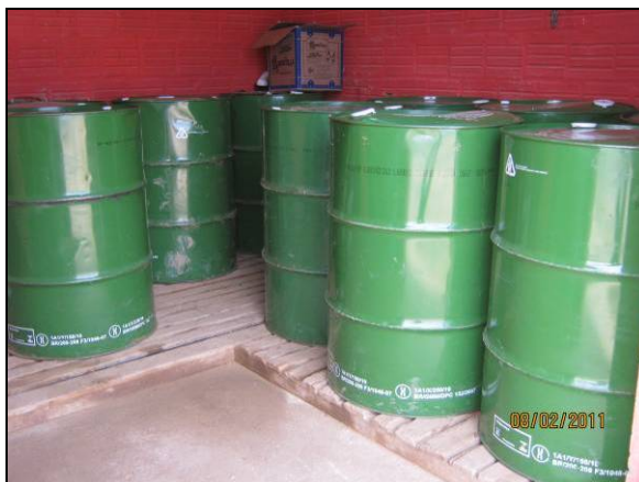
Foto 4.2.266. Armazenamento de lubrificantes sobre tablados e piso impermeabilizado (fev/11).
