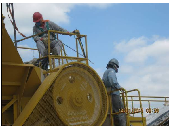
Foto 4.2.165. Uso correto do cinto de segurança para atividades em altura por colaborador no britador, WBS 1218 (jan/11).
