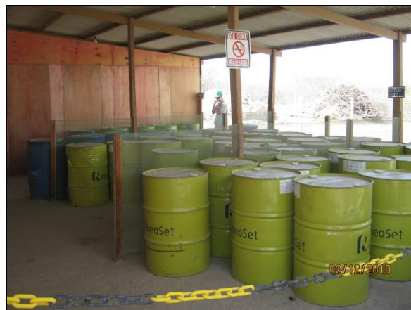
Foto 4.2.685. Armazenamento adequado de produtos químicos na central de concreto, WBS 2225 (dez/10).
