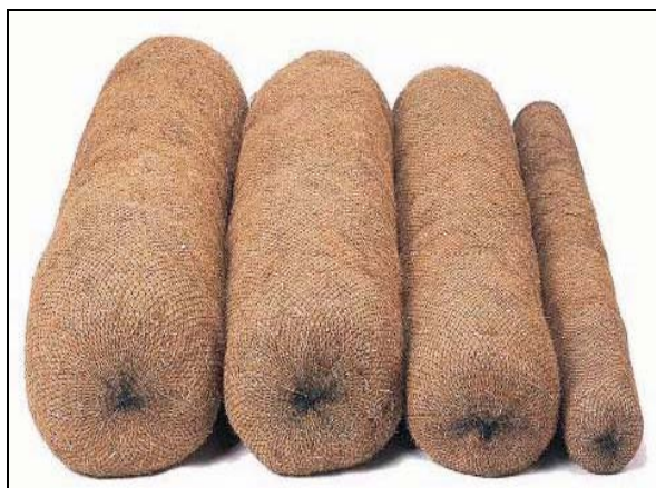
Foto 14: Bermalonga fabricada industrialmente com fibras vegetais, prensadas e envolvidas por uma rede resistente de polipropileno.
