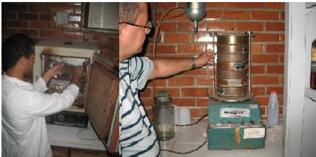
Figura 11 – Secagem do sedimento em estufa e separação das frações granulométricas no Rotape.
