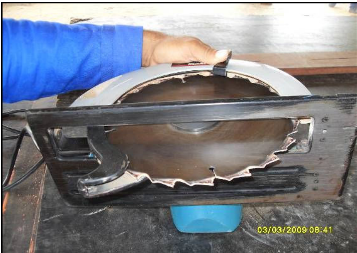
SERRA CIRCULAR MANUAL (PROTEÇÃO COLETIVA COIFA).
