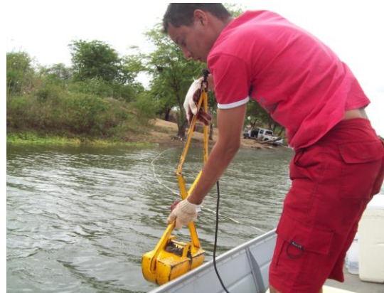
Foto 10: Uso da Draga para coleta de sedimentos de fundo para análises de zoobentos e granulométrica, na estação amostral Q02.
