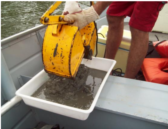
Foto 15: Amostra de sedimento para análises de zoobentos associados a sedimento de fundo e de granulometria.
