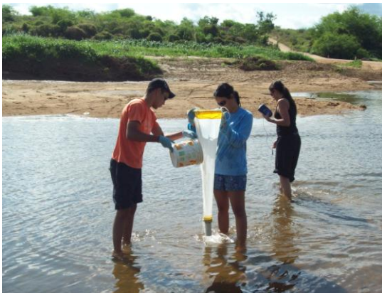
Foto 09: Coleta de zooplâncton através de filtragem de volume conhecido e medição de pH, na estação amostral Q71.
