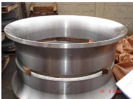
**Figura 3.7:** Cinta do Rotor da Bomba
