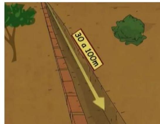
5º - O canal deve ter um comprimento mínimo de 30 m e máximo de 100 m.
