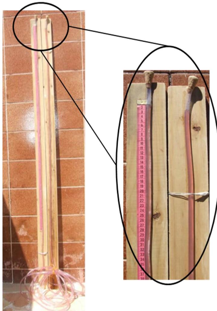
**Figura 17 – Mangueira de nível: destaque para a utilização de rolhas nas pontas para evitar a perda de água**
