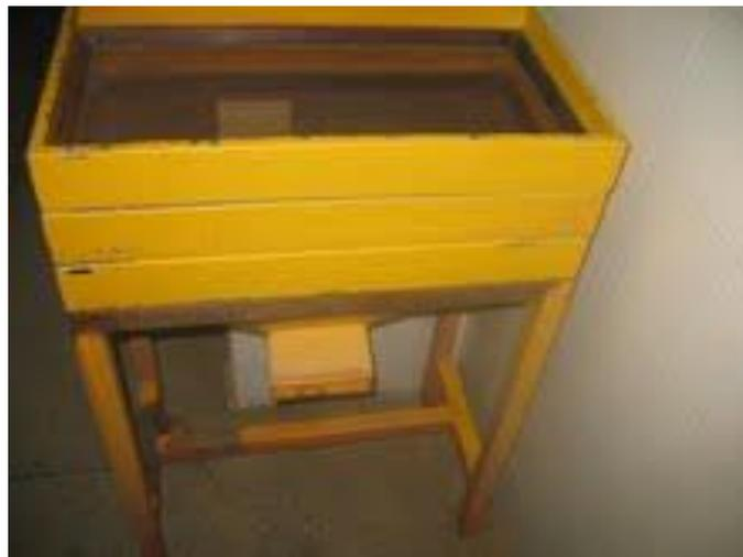
Figura 2.5 – Peneiras granulométricas utilizadas na lavagem dos sedimentos.
