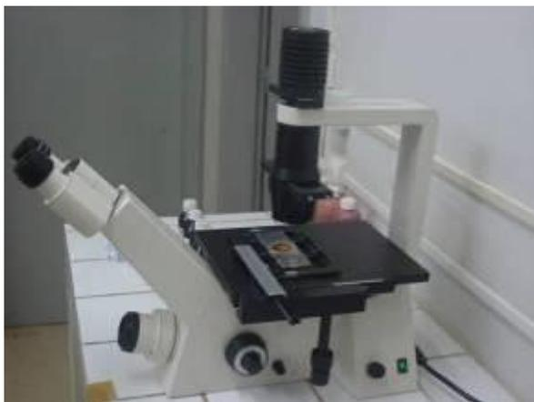
Figura 2.2 – Microscópio invertido
