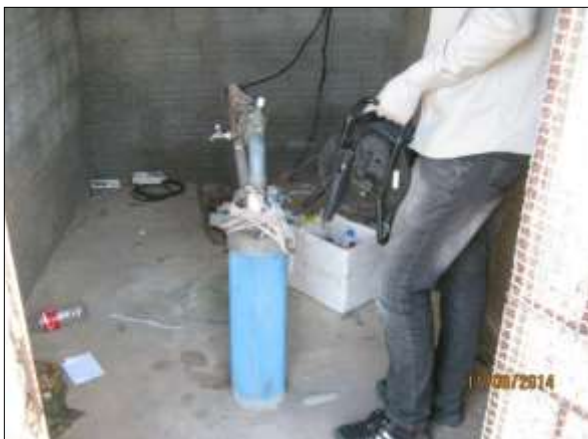
Foto 4.26.9. Mensuração do nível da água no poço 5 A, Salgueiro - PE (ago/2014).
