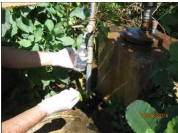
Foto 4.26.3. Coleta de água para análise de nitrato do poço 49, Sertânia - PE (ago/2014).
