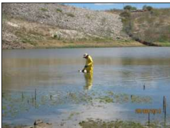
Foto 4.22 10. Estação amostral Q78 – Açude Barra do Juá. Coleta superficial de água para análise físico-química (ago/2014).
