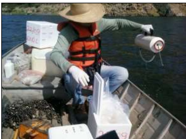
Foto 4.22 15. Estação amostral Q42 – Açude Coremas. Coleta de água com a Garrafa de Van Dorn (set/2014).
