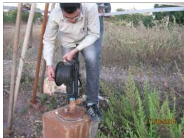
Foto 4.26.11. Mensuração do nível da água no poço 7A, Salgueiro - PE (ago/2014).
