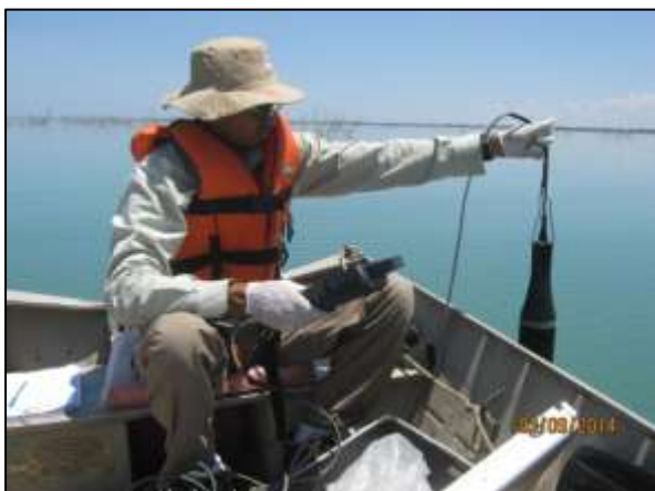
Foto 4.22 17. Estação amostral Q54 – Reservatório Itaparica, Captação do Eixo Leste. Obtenção de dados com a sonda multiparamétrica (set/2014).
