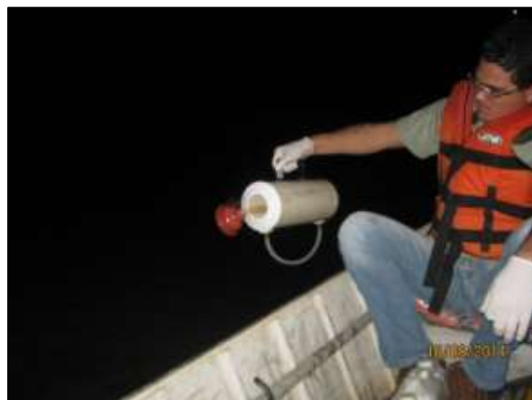
Foto 4.22 18. Estação amostral Q48 – Açude Armando Ribeiro Gonçalves. Utilização da Garrafa de Van Dorn para coleta de água superficial – Coleta Nictemeral (set/2014).
