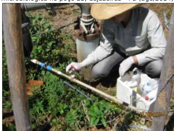
Foto 4.26.6. Esterilização da tomada d'água pelo método da flambagem no poço 13, Brejo Santo - CE (ago/2014).
