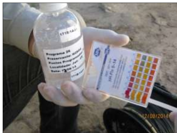
Foto 4.26.10. Conservação química da amostra para análise de nitrato no poço 8, Jati - CE (ago/2014).
