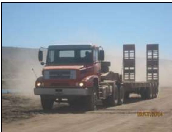
Foto 4.2.284. Veículo utilizado no transporte seguro de equipamento pesado (jul/2014).
