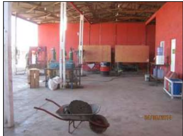
Foto 4.2.439. Oficina mecânica coberta, piso impermeável e barreira de contenção (ago/2014).
