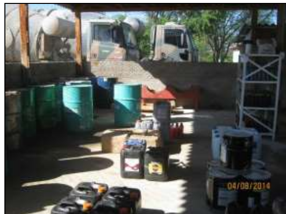
Foto 4.2.408. Resíduos perigosos dispostos em área coberta, ventilada, piso impermeabilizado e extintor de incêndio (ago/2014).
