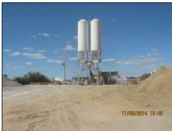
Foto 4.2.114. Central de concreto em operação no canteiro de obras de Penaforte - CE (jun/2014).
