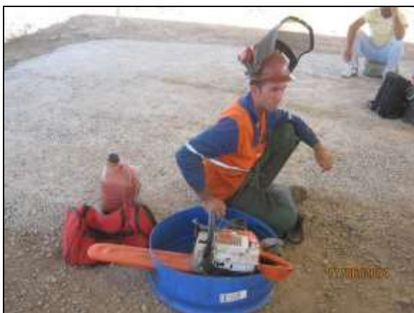
Foto 4.2.321. Bacia de contenção para o abastecimento de motosserras (jun/2014).
