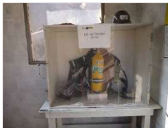
Foto 4.2.582. Kit autônomo de ar disponível na frente de serviço do emboque do túnel Cuncas I (maio/2014).
