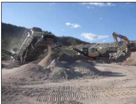
Foto 4.2.320. Britador móvel em funcionamento no segmento de canal - WBS 1234 (ago/2014).
