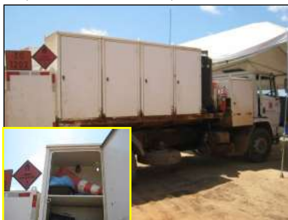
Foto 4.2.323. Caminhão comboio equipado com kit emergência (set/2014).
