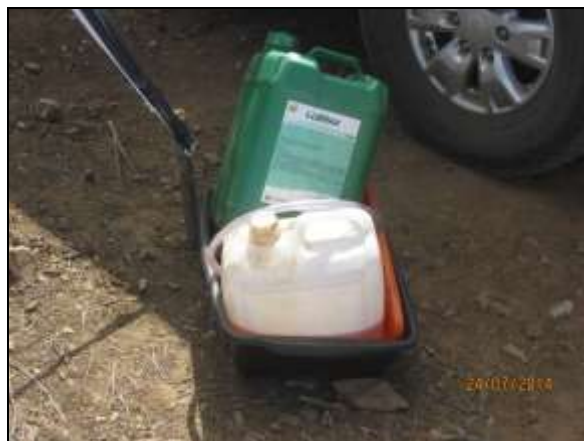
Foto 4.2.853. Bandeja de contenção utilizada no abastecimento de motosserras, durante supressão mecanizada pela equipe da CVR na VPR Ipê (jul/14).
