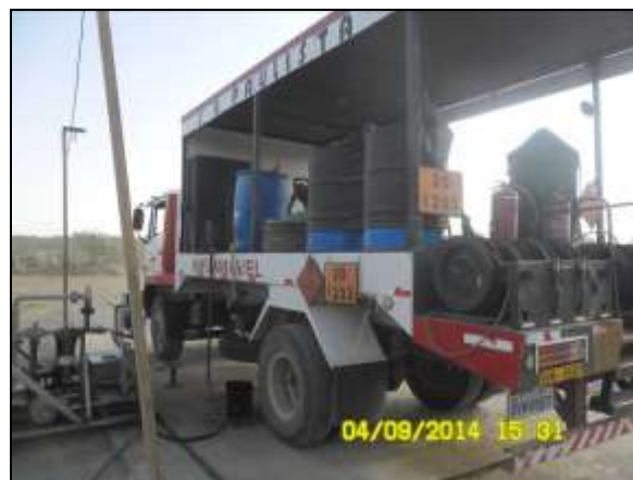
Foto 4.2.447. Caminhão comboio utilizado para abastecimento de veículos nas frentes de serviço (set/2014).
