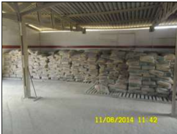
Foto 4.2.504. Acondicionamento adequado de cimento utilizado na central de concreto (jun/2014).
