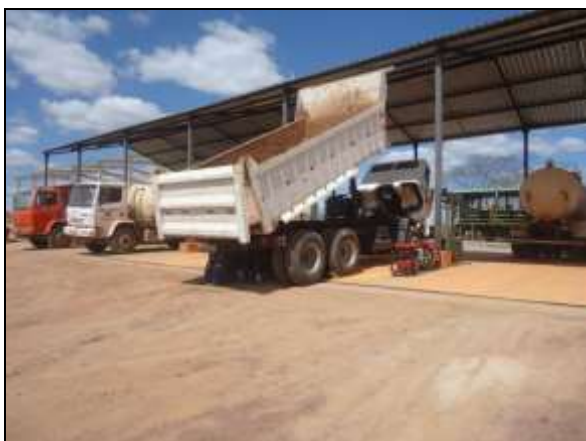
Foto 4.2.309. Oficina mecânica no canteiro central (antigo Lote 06), com canaleta, extintores de incêndio e piso impermeabilizado (ago/2014).
