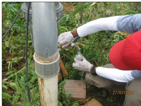
Foto 58. Coleta de água para análise de nitrato.
