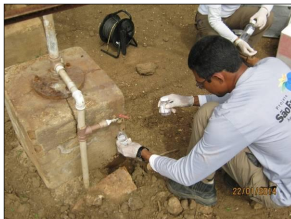
Foto 30. Coleta de água para análise microbiológica.
