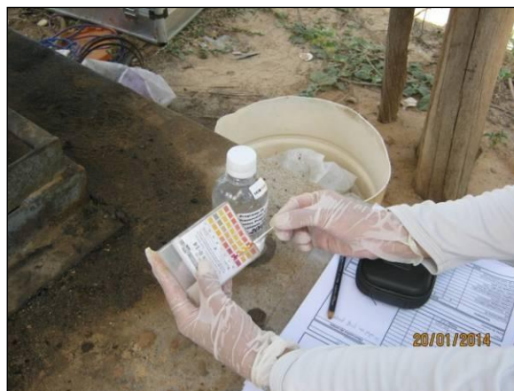
Foto 6. Preservação química da amostra de água para análise de nitrato.
