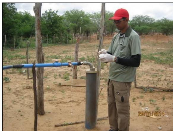
Foto 36. Coleta de água para análise microbiológica.
