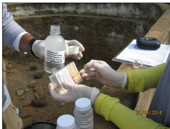
Foto 16. Coleta de água para análise de nitrato e preservação química da amostra.
