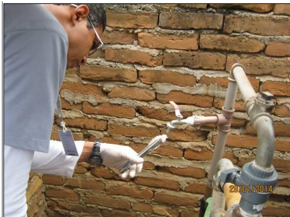
Foto 75. Esterilização da torneira pelo método da flambagem.
