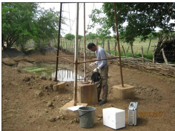
Foto 29. Mensuração do nível da água do poço.
