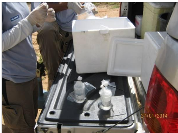
Foto 49. Acondicionamento das amostras de água nos isopores contendo gelo para encaminhamento ao laboratório.
