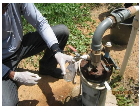
Foto 4. Coleta de água para análise de nitrato.
