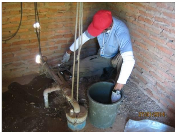
Foto 47. Coleta de água para obtenção de dados com a sonda multiparâmetros.
