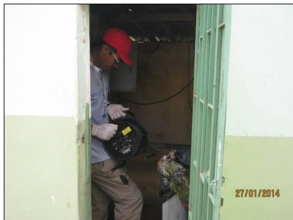
Foto 54. Mensuração do nível estático da água do poço.
