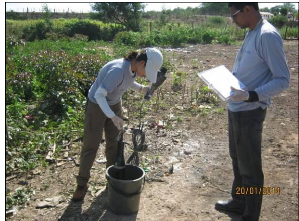
Foto 12. Obtenção de dados com a sonda multiparâmetros.
