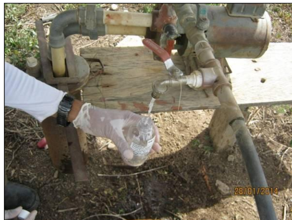
Foto 72. Coleta de água para análise de nitrato.
