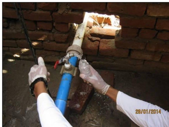
Foto 80. Coleta de água para análise microbiológica.
