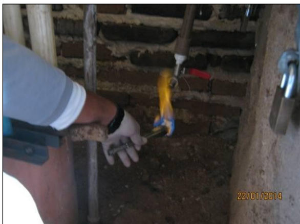
Foto 31. Esterilização da torneira pelo método da flambagem.
