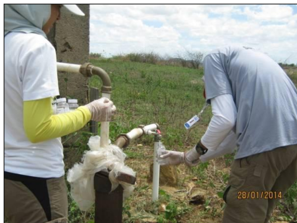
Foto 82. Coleta de água para análise de nitrato.
