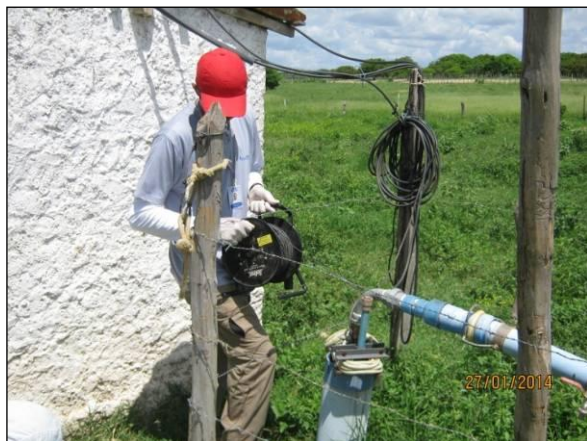
Foto 59. Mensuração do nível estático da água do poço.
