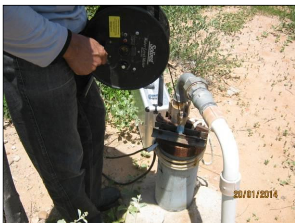
Foto 3. Mensuração do nível estático da água do poço.
