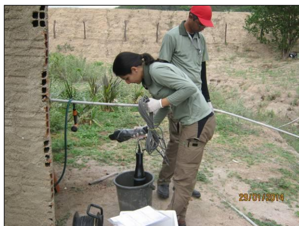
Foto 38. Obtenção de dados com a sonda multiparâmetros.
