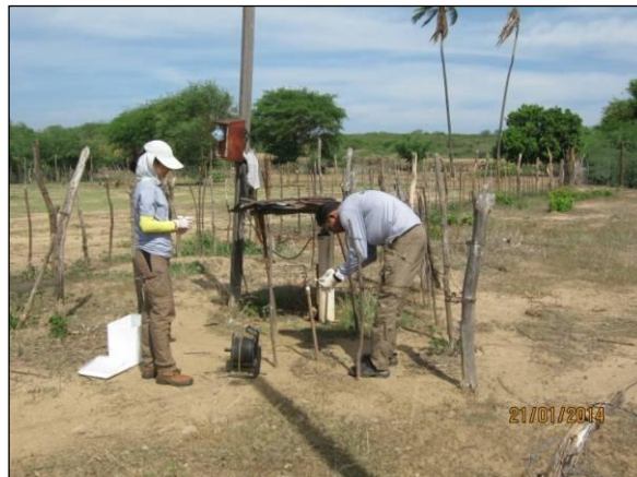
Foto 20. Esterilização da torneira pelo método da flambagem.
