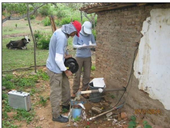
Foto 51. Mensuração do nível da água do poço.
