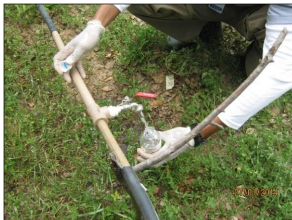
Foto 56. Coleta de água para análise de nitrato.
