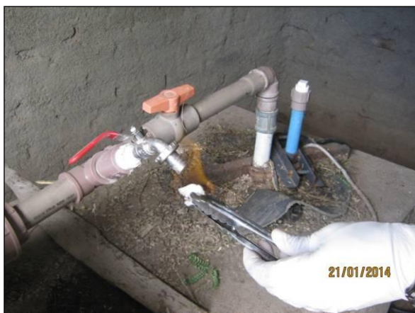
Foto 25. Esterilização da torneira pelo método da flambagem.
