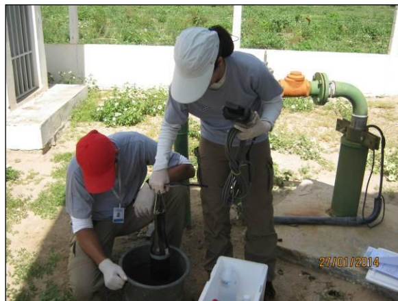
Foto 50. Obtenção dos dados com a sonda multiparâmetros.
