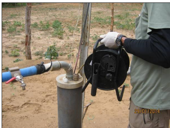
Foto 35. Mensuração do nível estático da água do poço.
