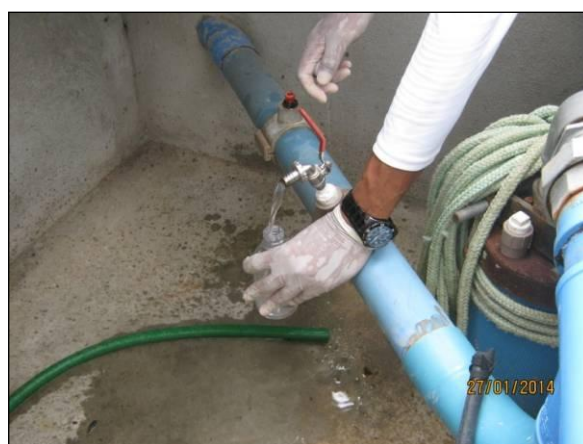
Foto 64. Coleta de água para análise de nitrato.
