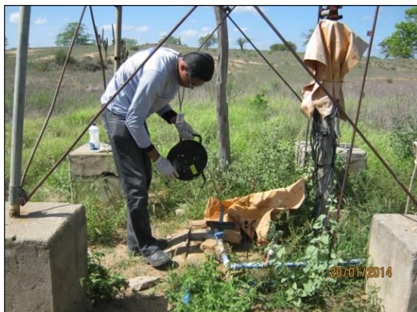
Foto 9. Mensuração do nível da água do poço.
