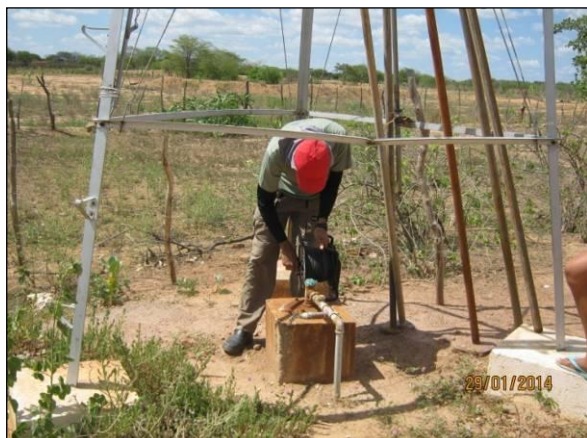
Foto 41. Mensuração do nível estático da água do poço.
