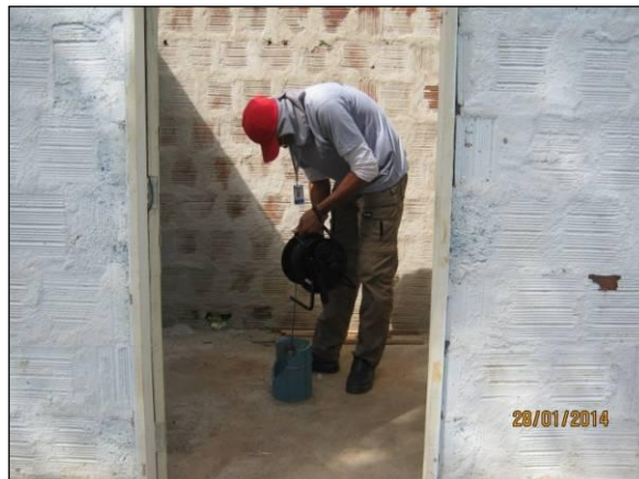
Foto 78. Mensuração do nível estático da água do poço.
