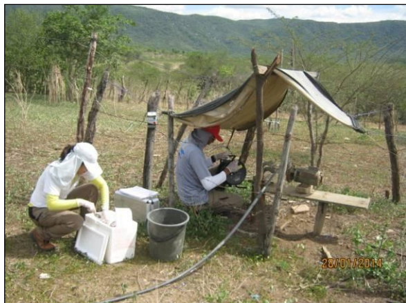
Foto 71. Mensuração do nível estático da água do poço.
