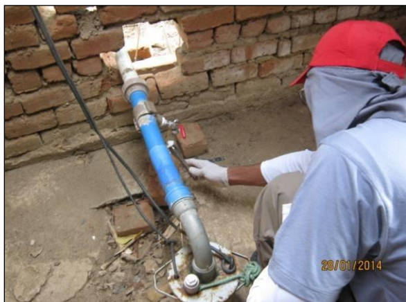
Foto 79. Esterilização da torneira pelo método da flambagem.
