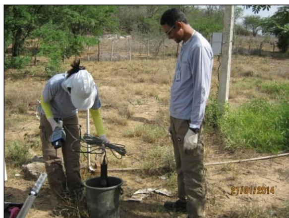
Foto 18. Obtenção de dados com a sonda multiparâmetros.
