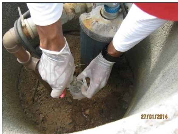
Foto 61. Coleta de água para análise microbiológica.
