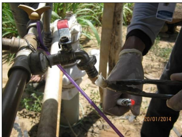
Foto 5. Esterilização da torneira pelo método de flambagem.
