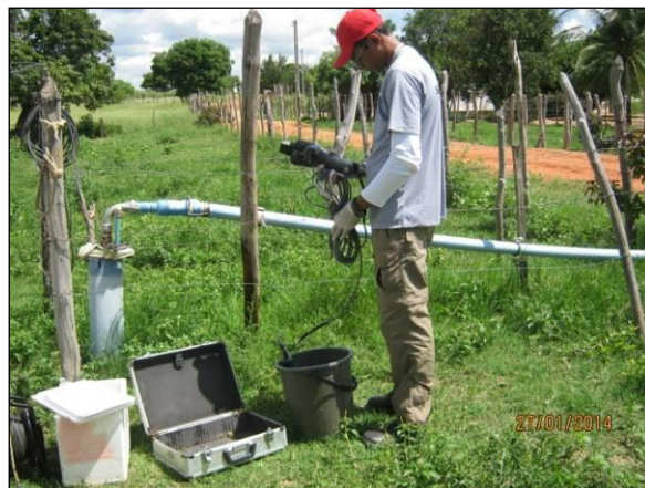
Foto 60. Obtenção dos dados com a sonda multiparâmetros.
