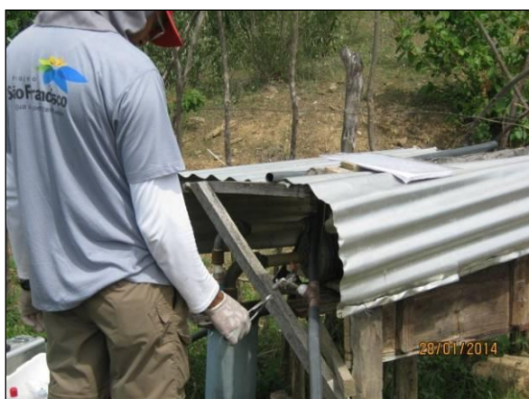
Foto 73. Flambagem da torneira para posterior coleta de água.
