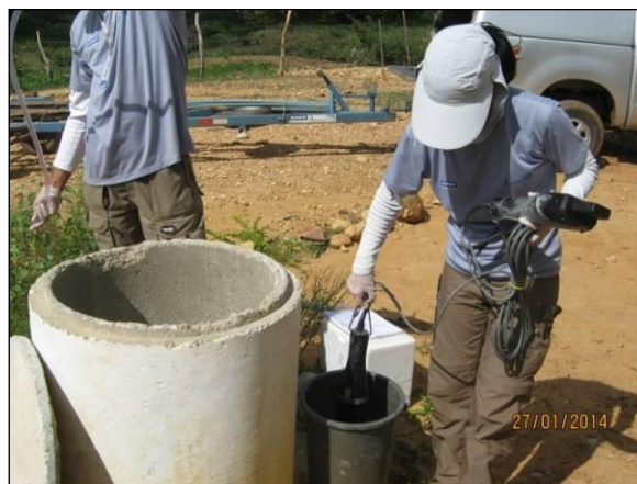
Foto 62. Obtenção de dados com a sonda multiparâmetros.
