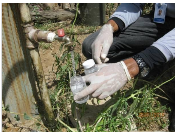
Foto 7. Coleta de água para análise microbiológica.
