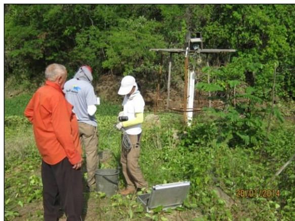
Foto 68. Obtenção de dados com a sonda multiparâmetros.
