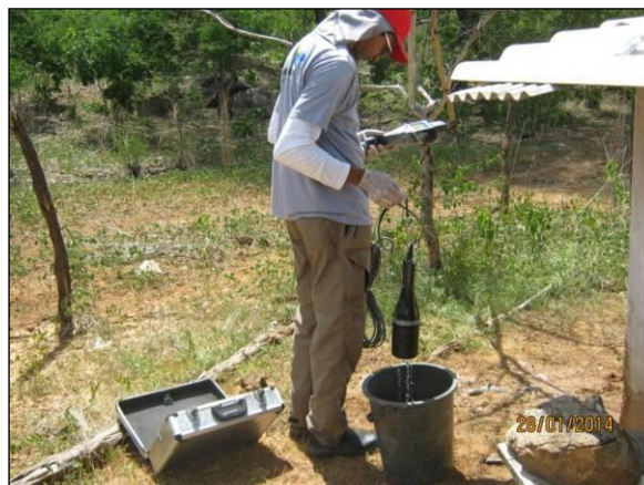
Foto 84. Obtenção de dados com a sonda multiparâmetros.
