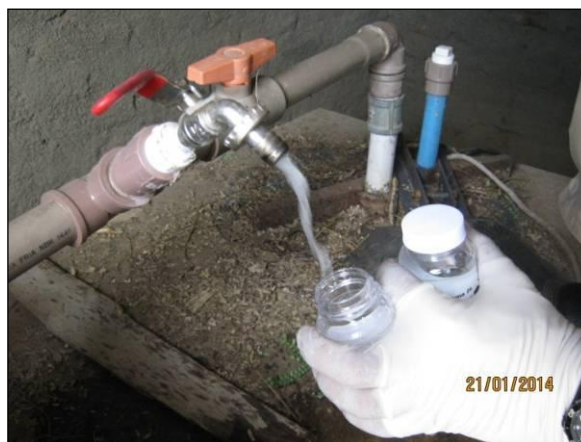
Foto 26. Coleta de água para análise microbiológica.
