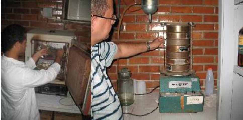
Figura 2.9 – Secagem do sedimento em estufa e separação das frações granulométricas no Rotape.
