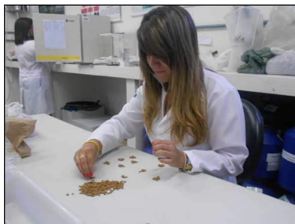
Foto 4.23.14. Determinação do peso de mil sementes, um parâmetros de caracterização dos lotes de sementes coletadas no período de abril a setembro de 2012, nas áreas do PISF.
