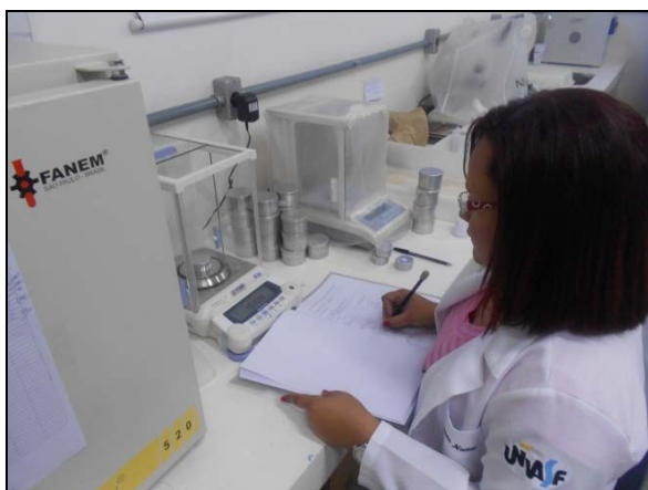
Foto 4.23.13. Determinação do teor de umidade das sementes, um parâmetros de caracterização dos lotes de sementes coletadas no período de abril a setembro de 2012, nas áreas do PISF.
