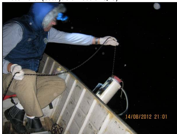
Foto 4.22.78. Coleta de água no fundo com a garrafa de Van Dorn - Coleta Nicteмерal (estação amostral Q73).
