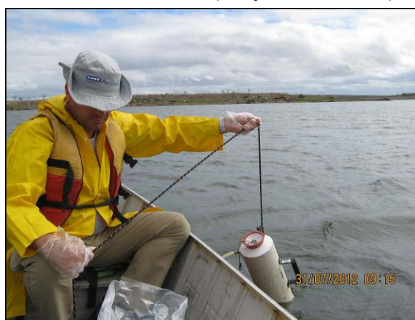
Foto 4.22.94. Coleta de água no fundo com a garrafa de Van Dorn - Coleta Nictemeral (estação amostral Q81).
