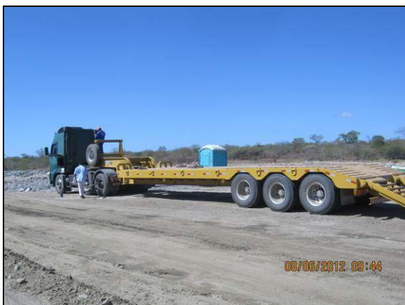
Foto 4.21.76. Caminhão prancha utilizado para o transporte de maquinário pesado (jun//2012).
