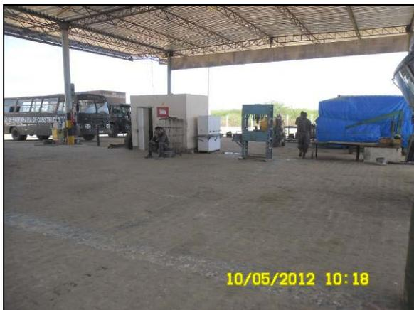
Foto 4.2.18. Oficina mecânica com piso impermeabilizado e canaletas de direcionamento do efluente para o SAO (maio/2012).
