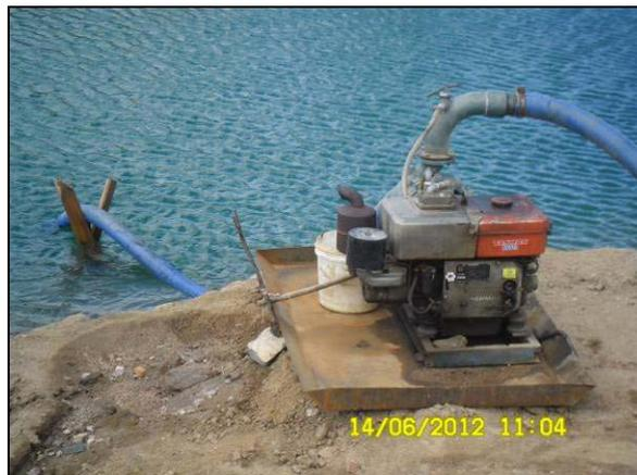
Foto 4.2.149. Motobomba disposto sobre bandeja coletora, WBS 1216 (jun/2012).
