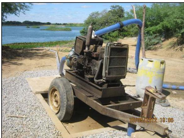
Foto 4.2.26. Motobomba instalado sobre bacia de contenção ligada ao SAO no canal de aproximação (maio/2012).
