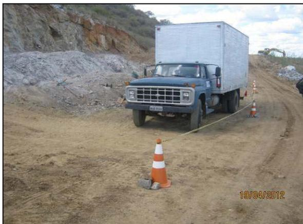
Foto 4.2.349. Paiol móvel para armazenamento e transporte dos explosivos sinalizado (abr/2012).
