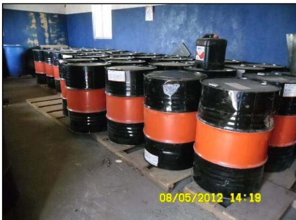
Foto 4.2.88. Armazenamento de tambores de óleos lubrificantes em área coberta e com piso impermeabilizado (maio/2012).
