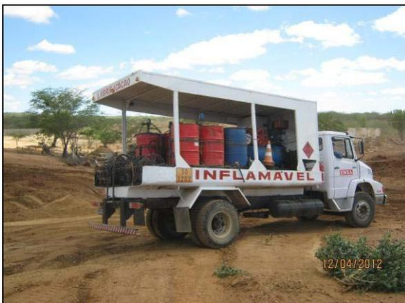
Foto 4.2.283. Melosa para abastecimento de máquinas nas frentes de serviço com kit mitigação (abr/2012).
