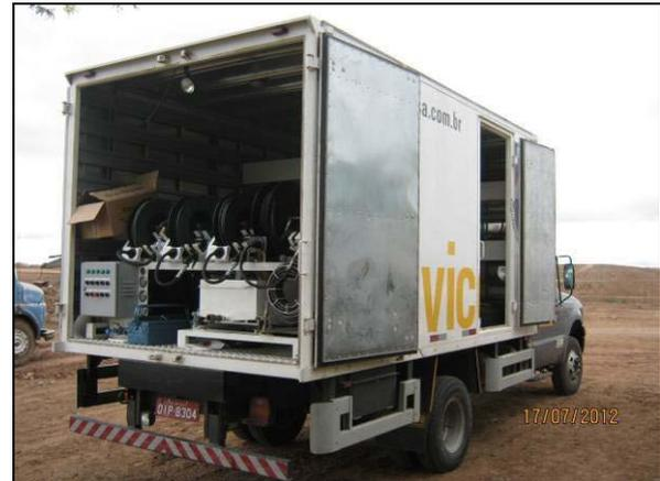
Foto 4.2.56. Caminhão comboio para lubrificação e abastecimento de máquinas no WBS 2204 (jul/2012).
