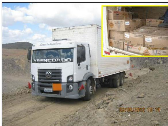
Foto 4.2.255. Armazenamento e transporte dos acessórios e explosivos em paiol móvel na EBI-1 (maio/2012).
