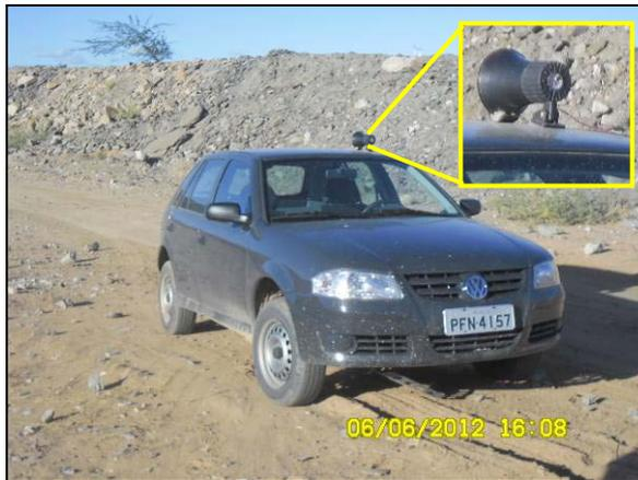
Foto 4.2.161. Veículo adaptado com sirene de alerta de segurança percorrendo a área antes da detonação (jun/2012).
