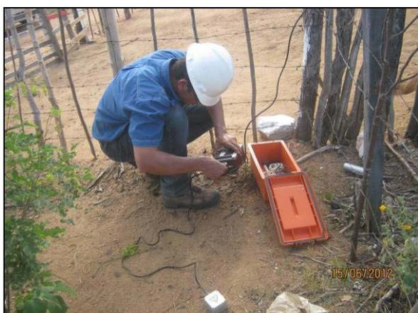
Foto 4.2.351. Instalação de sismógrafo para o acompanhamento do desmonte de rocha no WBS 2224 (jun/2012).
