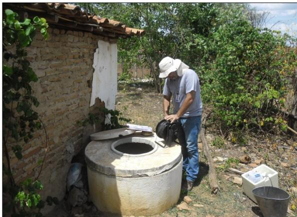
Foto 51. Mensuração do nível estático da água do poço (fev/2017).
