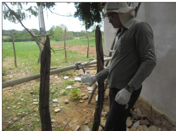
Foto 68. Coleta de água para análise físico-química e microbiológica (fev/2017).
