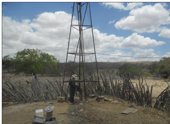
Foto 9. Mensuração do nível estático da água do poço (jan/2017).
