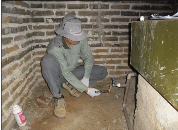
Foto 33. Flambagem da torneira anterior à coleta de amostras de água (fev/2017).
