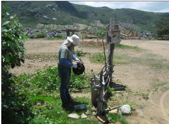
Foto 71. Mensuração do nível estático da água do poço (fev/2017).
