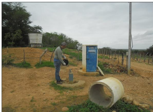
Foto 63. Mensuração do nível estático da água do poço (fev/2017).
