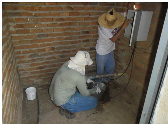
Foto 82. Coleta de água para leitura de parâmetros físico-químicos utilizando a sonda (fev/2017).
