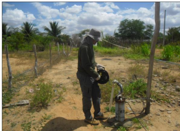
Foto 5. Mensuração do nível estático da água do poço (jan/2017).
