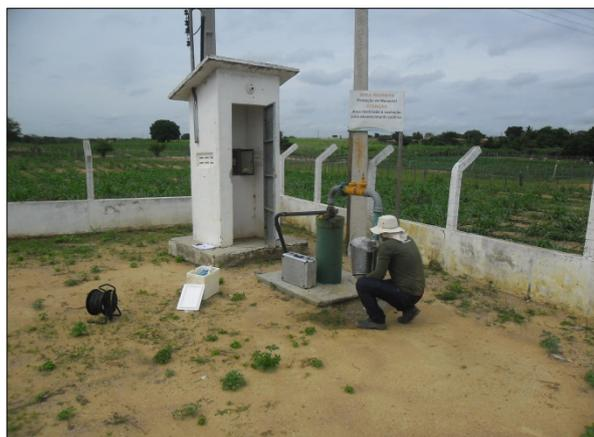
Foto 47. Coleta de água para análise físico-química utilizando a sonda multiparâmetros (fev/2017).
