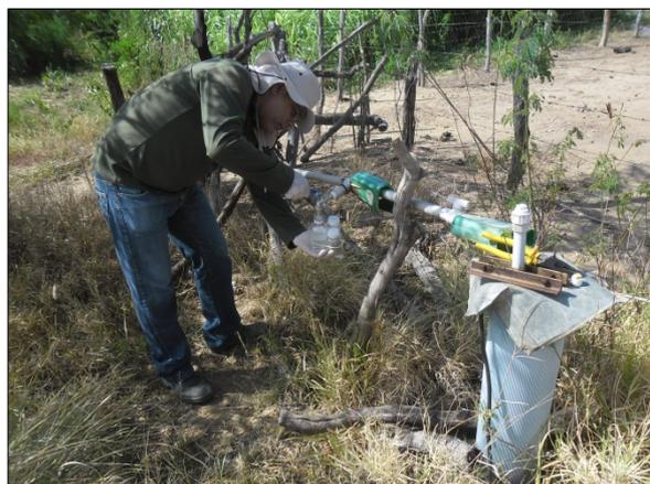
Foto 20. Coleta de amostras de água para análise físico-química e microbiológica (jan/2017).
