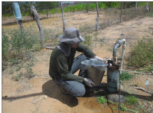
Foto 6. Coleta de amostra de água para obtenção dos dados físico-químicos utilizando a sonda multiparâmetros (jan/2017).
