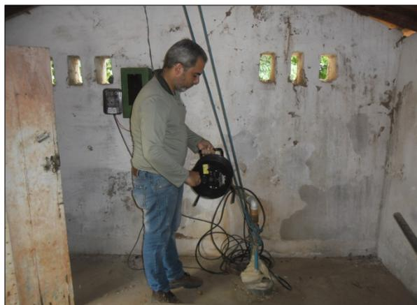
Foto 67. Mensuração do nível estático da água do poço (fev/2017).
