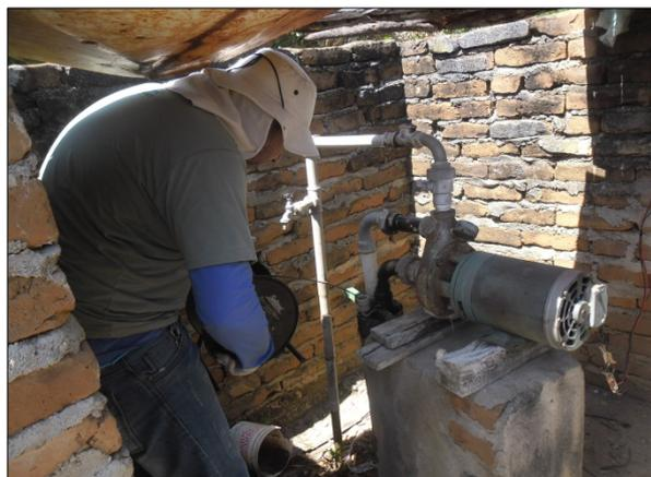
Foto 77. Mensuração do nível estático da água do poço (fev/2017).
