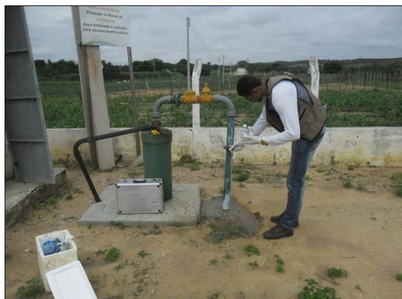
Foto 48. Extravasamento de água anterior a coleta de amostras (fev/2017).
