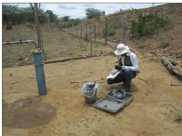
Foto 38. Análise físico-química da água utilizando a sonda multiparâmetros (fev/2017).
