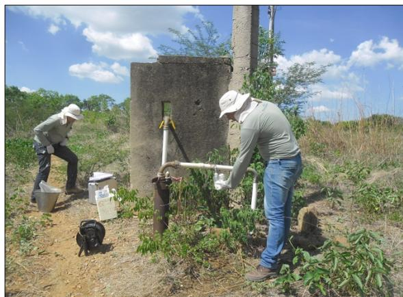
Foto 84. Coleta de amostras de água para análise físico-química e microbiológica (fev/2017).
