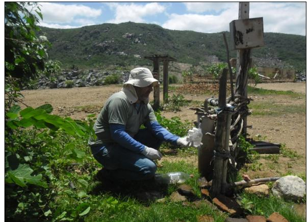
Foto 72. Coleta de água para análise físico-química e microbiológica (fev/2017).
