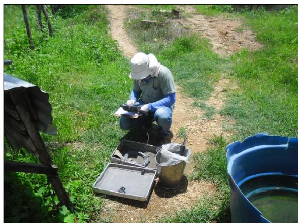
Foto 76. Análise físico-química da água utilizando a sonda multiparâmetros (fev/2017).
