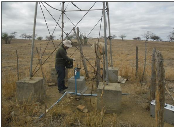
Foto 11. Mensuração do nível estático da água do poço (jan/2017).
