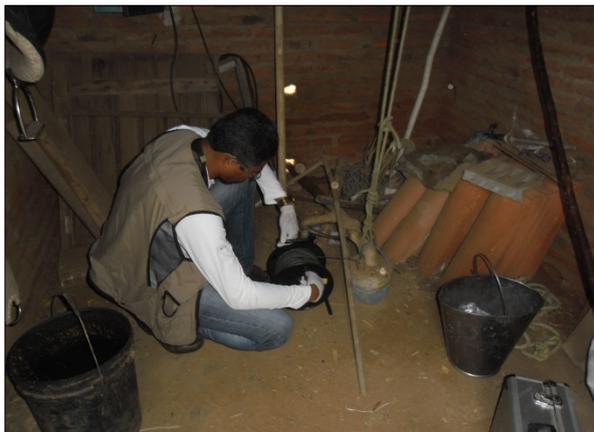
Foto 55. Mensuração do nível estático da água do poço (fev/2017).
