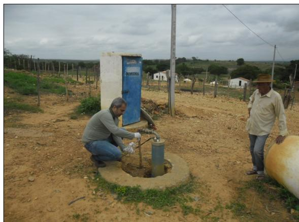
Foto 64. Coleta de água para análise físico-química e microbiológica (fev/2017).
