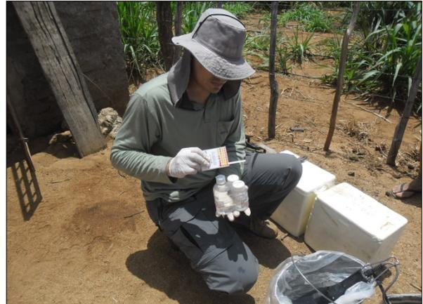
Foto 34. Análise físico-química da água utilizando a sonda multiparâmetros e conservação química da amostra (fev/2017).
