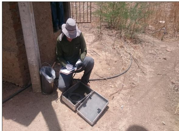
Foto 28. Obtenção de parâmetros físico-químicos da água do poço utilizando a sonda multiparâmetros (jan/2017).
