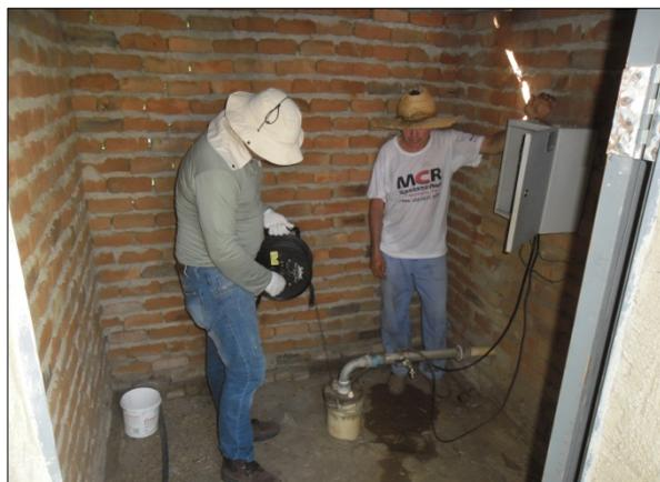
Foto 81. Mensuração do nível estático da água do poço (fev/2017).
