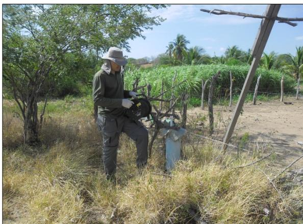
Foto 19. Aferição do nível estático da água (jan/2017).
