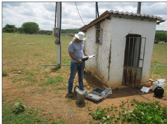
Foto 60. Análise físico-química da água utilizando a sonda multiparâmetros (fev/2017).
