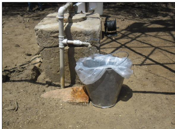
Foto 32. Coleta de água para análise físico-química utilizando a sonda multiparâmetros (fev/2017).
