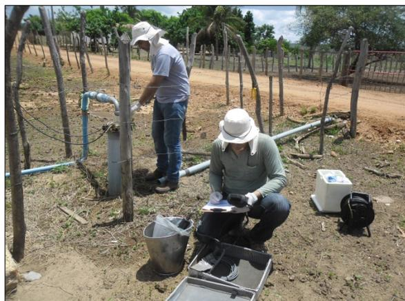
Foto 62. Coleta de amostras de água e análise físico-química utilizando a sonda multiparâmetros (fev/2017).
