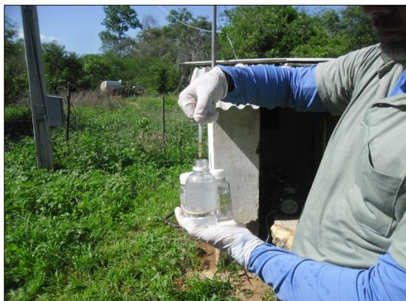
Foto 86. Conservação química da amostra de água para análise de nitrato (fev/2017).
