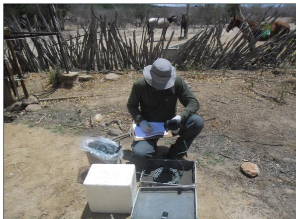
Foto 10. Obtenção de parâmetros físico-químicos da água do poço utilizando a sonda multiparâmetros (jan/2017).
