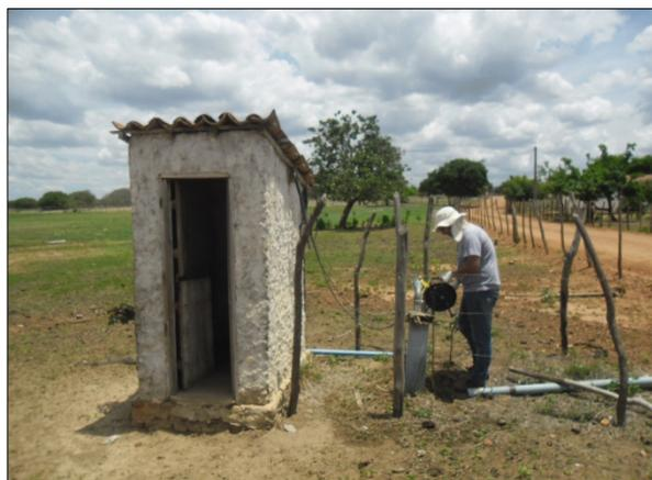
Foto 61. Mensuração do nível estático da água do poço (fev/2017).
