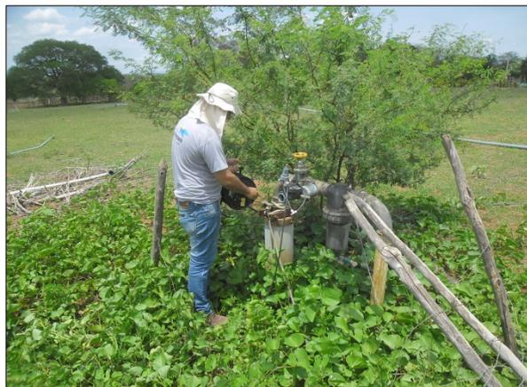
Foto 59. Mensuração do nível estático da água do poço (fev/2017).
