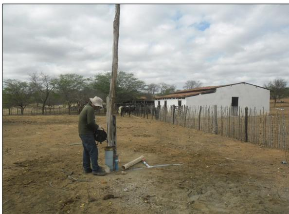
Foto 15. Mensuração do nível estático da água do poço (jan/2017).
