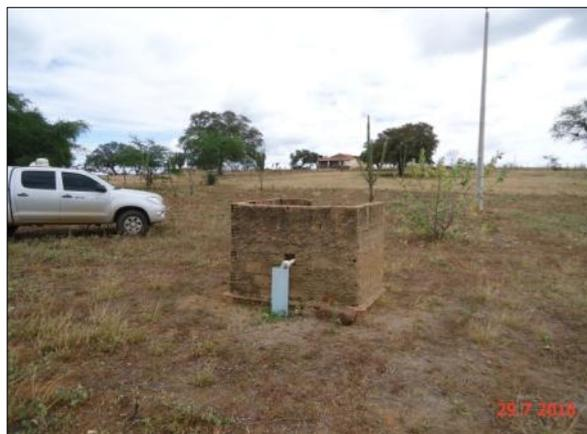
Foto 40. Impedimento no interior do tubo guia impossibilitou a mensuração do nível estático (jul/2016).
