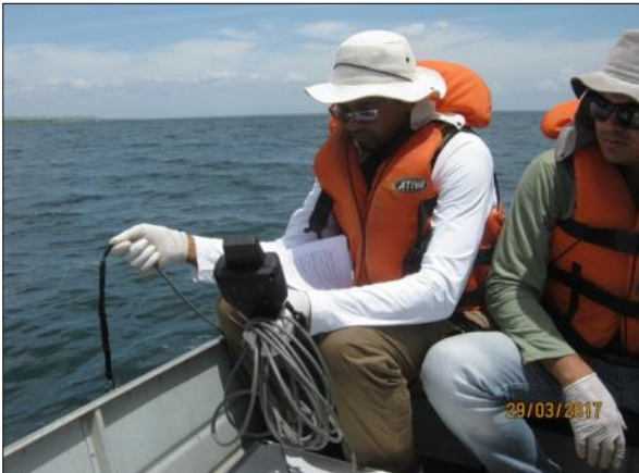
Foto 51. Coleta de dados físico-químicos utilizando a sonda multiparâmetros (29/03/2017).
