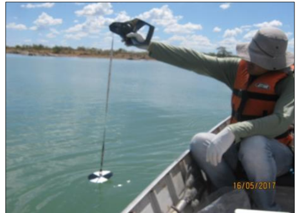
Foto 10. Avaliação da transparência da água utilizando o disco de Secchi (16/05/2017).
