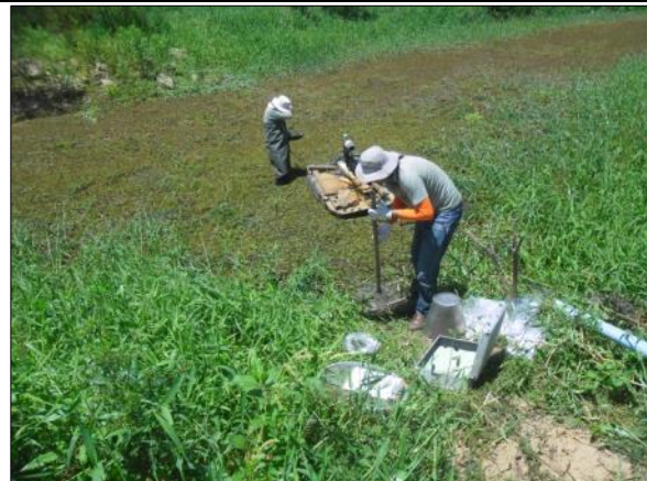
Foto 102. Coleta de sedimentos para análise granulométrica (04/04/2017).
