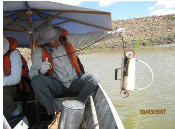
Foto 124. Coleta de amostra de água em profundidade com o auxílio da garrafa de van Dorn (20/03/2017).
