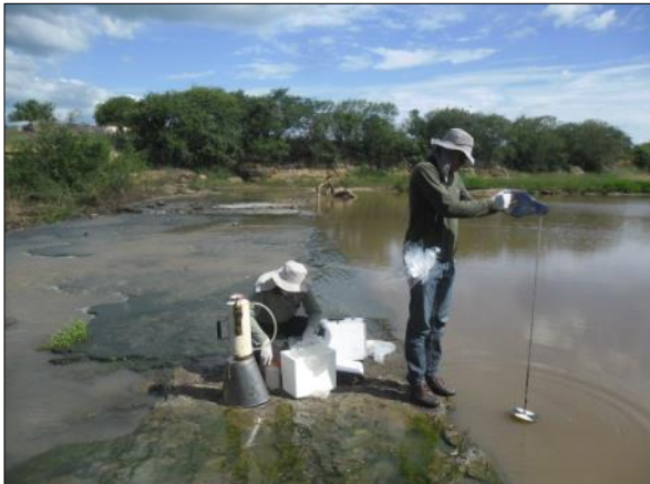
Foto 105. Coleta de amostras de água para análise e avaliação da transparência da água utilizando o disco de Secchi (03/04/2017).
