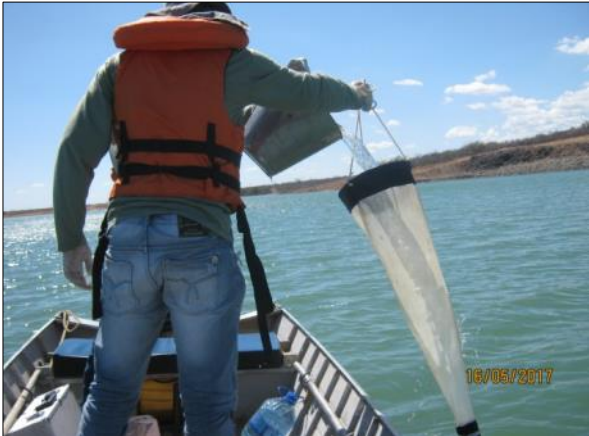
Foto 11. Coleta de amostra de água para ensaio de zooplâncton (16/05/2017).
