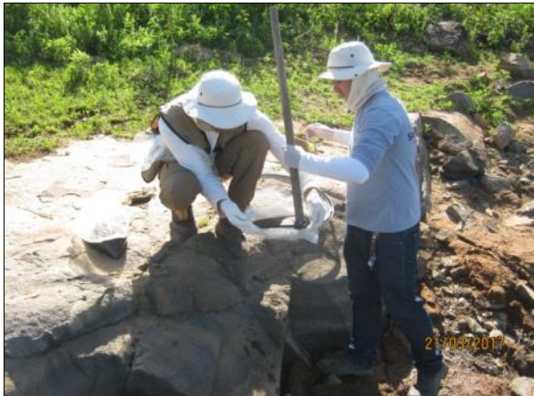
Foto 63. Coleta de sedimentos para análise granulométrica (21/03/2017).
