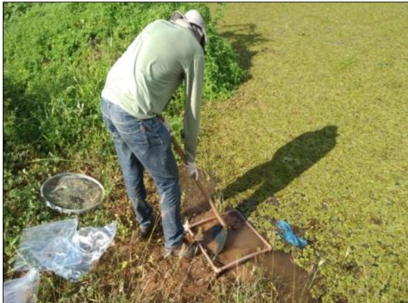
Foto 67. Coleta de zoobentos utilizando o método do quadrado (05/04/2017).
