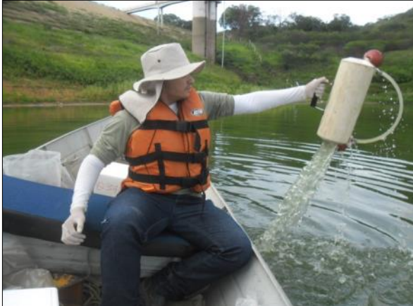
Foto 97. Coleta de amostras de água superficial com o auxílio da garrafa de van Dorn (04/04/2017).
