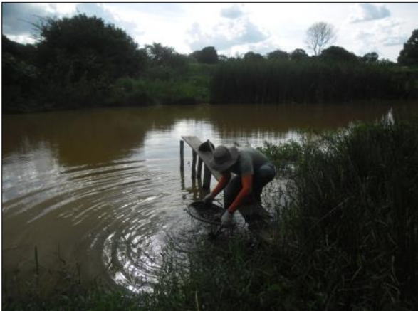
Foto 99. Coleta de sedimentos pelo método da peneira para ensaio de zoobentos (04/04/2017).
