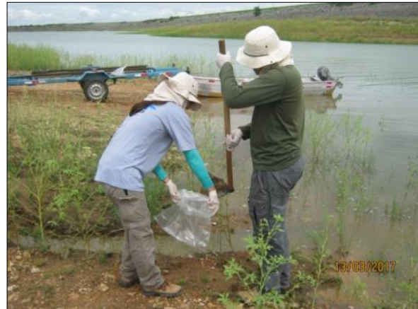
Foto 120. Coleta de sedimentos para análise granulométrica (13/03/2017).
