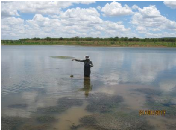
Foto 61. Coleta de dados físico-químicos utilizando a sonda multiparâmetros (21/03/2017).
