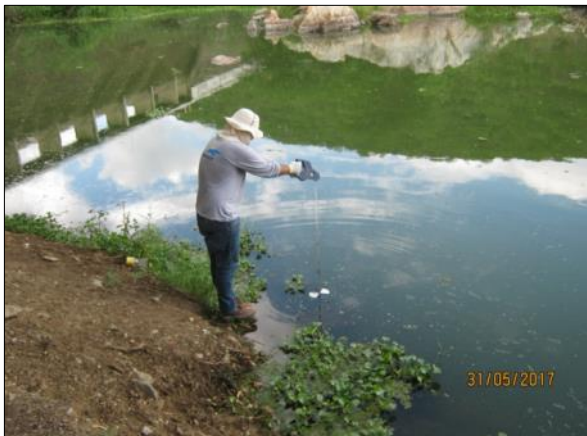
Foto 35. Avaliação da transparência da água utilizando o disco de Secchi (31/05/2017).
