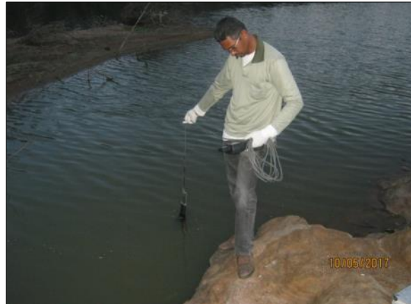
Foto 42. Obtenção de dados físico-químicos utilizando a sonda multiparâmetros (10/05/2017).
