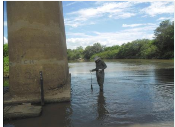
Foto 110. Coleta de dados físico-químicos utilizando a sonda multiparâmetros (03/04/2017).
