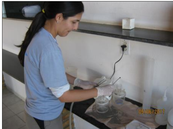
Foto 6. Filtração para determinação de metais nas amostras de água (05/06/2017).
