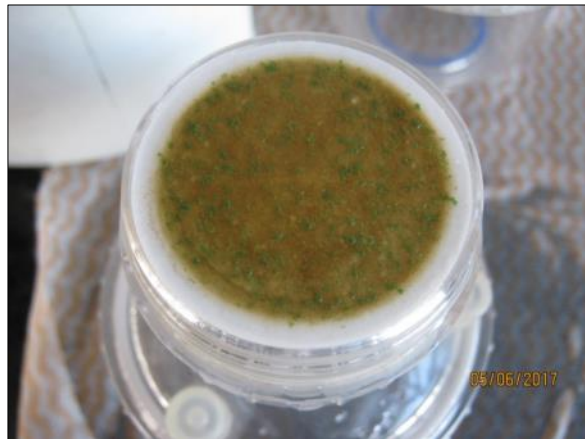
Foto 5. Filtração para determinação de clorofila-a e feofitina-a (05/06/2017).
