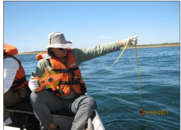
Foto 60. Medição da profundidade do reservatório (21/03/2017).
