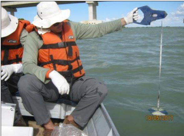
Foto 127. Avaliação da transparência da água utilizando o disco de Secchi (10/05/2017).
