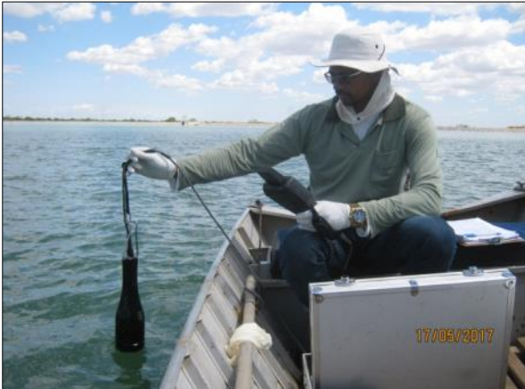
Foto 15. Obtenção de dados físico-químicos utilizando a sonda multiparâmetros (17/05/2017).
