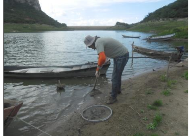
Foto 98. Coleta de sedimentos para análise granulométrica e de zoobentos (04/04/2017).
