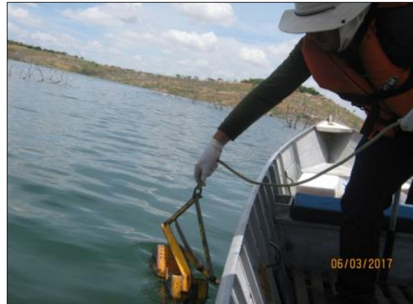
Foto 92. Coleta de sedimentos em profundidade com o auxílio da draga de Petersen (06/03/2017).
