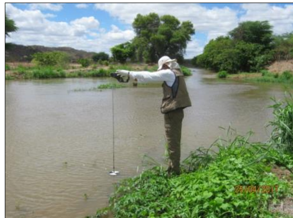
Foto 22. Avaliação da transparência da água utilizando o disco de Secchi (25/04/2017).
