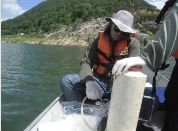
Foto 107. Coleta de amostra de água para análises físico-química e microbiológica (03/04/2017).
