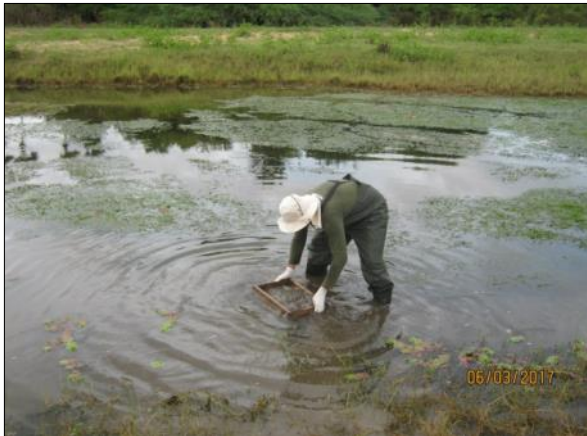
Foto 93. Coleta de zoobentos utilizando o método da peneira (06/03/2017).
