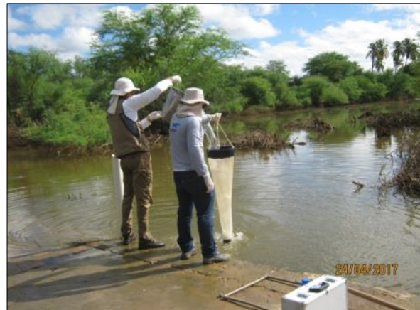
Foto 38. Coleta de água para ensaio de zooplâncton (24/04/2017).
