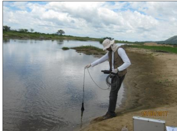
Foto 116. Obtenção de dados físico-químicos utilizando a sonda multiparâmetros (15/03/2017).
