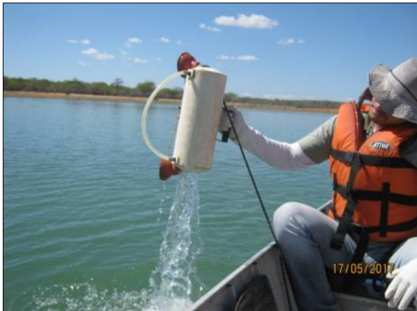
Foto 13. Coleta de amostra de água em profundidade utilizando a garrafa de van Dorn (17/05/2017).
