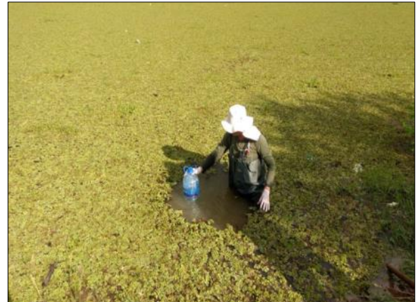
Foto 68. Coleta de amostra de água para análise de cianobactérias (05/04/2017).
