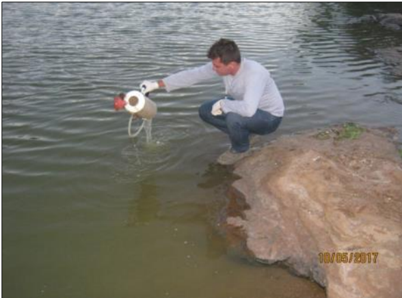
Foto 41. Coleta de amostra de água superficial com auxílio da garrafa de van Dorn (10/05/2017).
