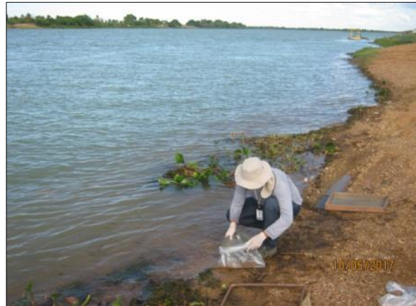
Foto 128. Coleta de sedimentos para análise granulométrica (10/05/2017).
