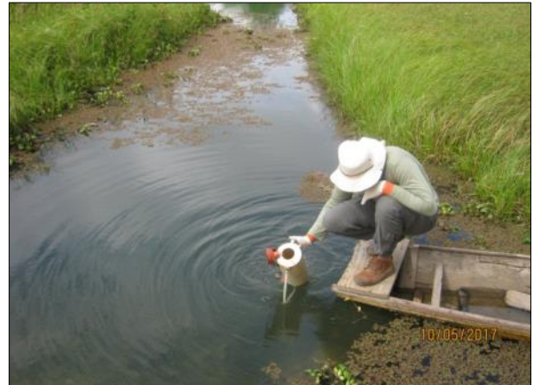
Foto 56. Coleta de água superficial utilizando a garrafa de Van Dorn (10/05/2017).
