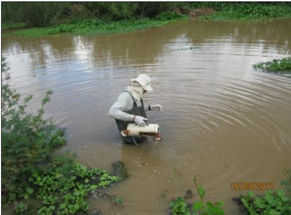
Foto 111. Coleta de amostras de água para análises físico-químicas e microbiológicas (15/03/2017).
