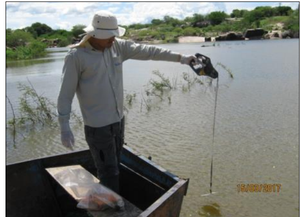
Foto 114. Avaliação da transparência da água utilizando o disco de Secchi (15/03/2017).
