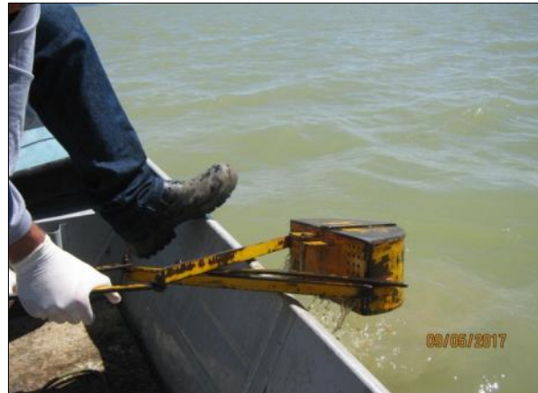
Foto 54. Coleta de sedimentos em profundidade com o auxílio da draga de Petersen (09/05/2017).
