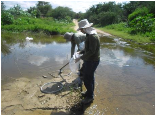
Foto 95. Coleta de sedimentos pelo método do quadrado para ensaio de zoobentos (05/04/2017).
