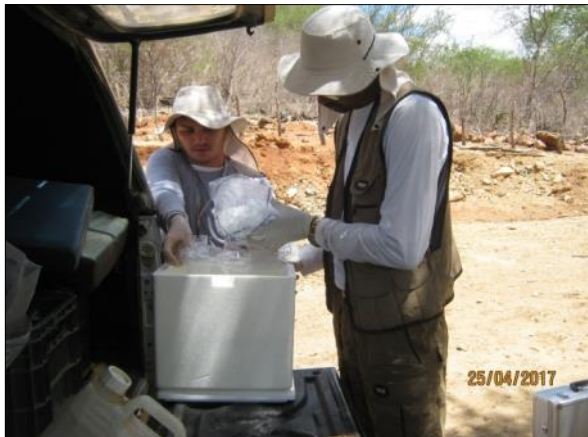
Foto 3. Preservação por resfriamento das amostras de água para análise físico-química e microbiológica (25/04/2017).
