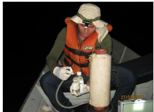
Foto 46. Coleta noturna de amostras de água para análises físico-químicas e microbiológicas (27/03/2017).
