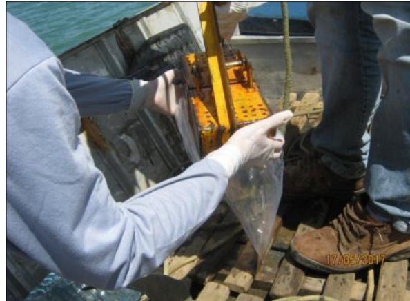
Foto 16. Coleta de zoobentos em profundidade utilizando a draga de Petersen (17/05/2017).
