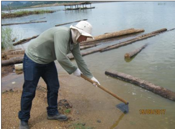
Foto 117. Coleta de sedimentos para análise granulométrica (15/03/2017).
