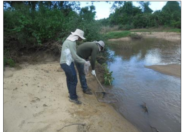
Foto 106. Coleta de sedimentos para análise de zoobentos utilizando o método do quadrado (03/04/2017).
