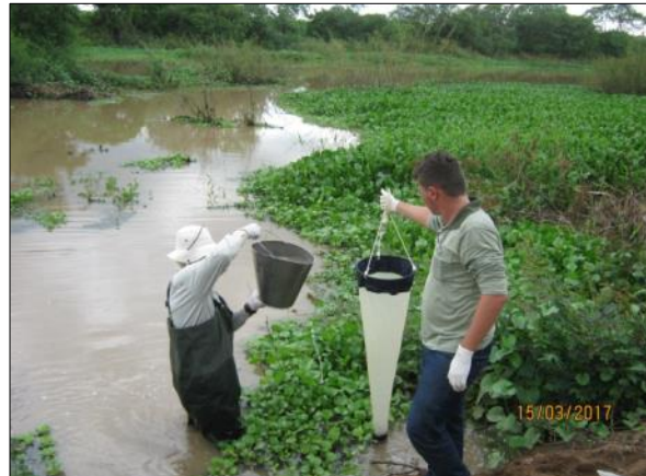
Foto 112. Coleta de amostra de água para análise de zooplâncton (15/03/2017).
