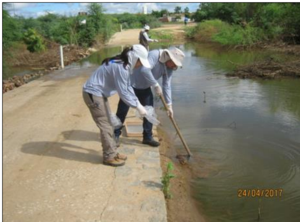
Foto 37. Coleta de sedimentos para análise granulométrica (24/04/2017).
