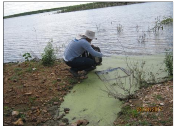
Foto 40. Coleta de macrófitas pelo método de quadrado para análise de biomassa (24/04/2017).
