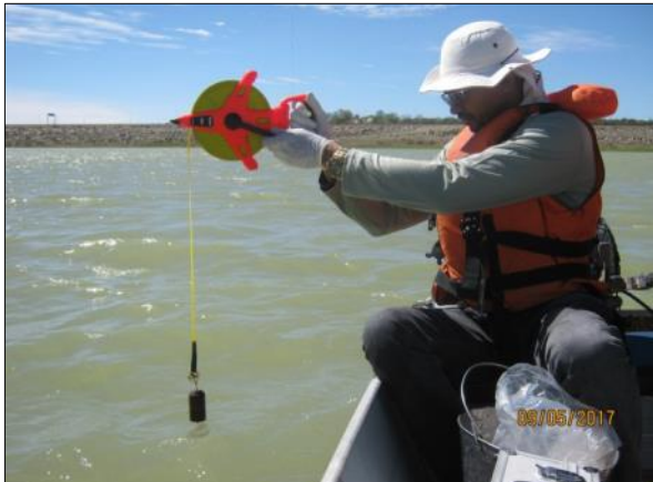
Foto 53. Medição da profundidade do reservatório (09/05/2017).
