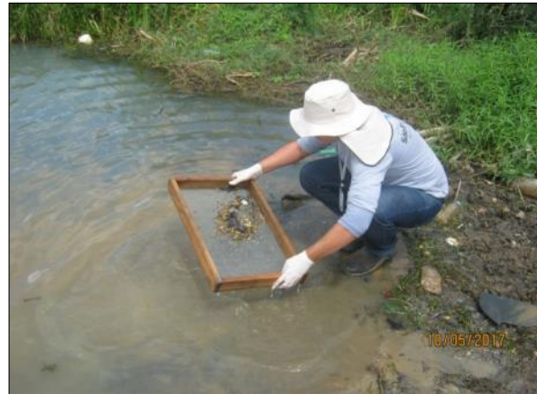
Foto 58. Coleta de zoobentos utilizando o método da peneira (10/05/2017).
