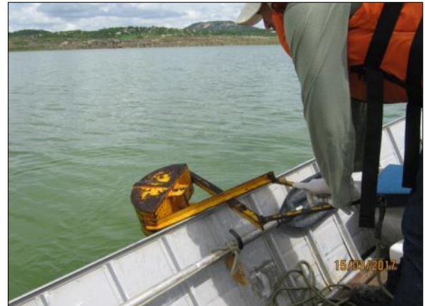
Foto 118. Coleta de sedimentos em profundidade com o auxílio da draga de Petersen (15/03/2017).
