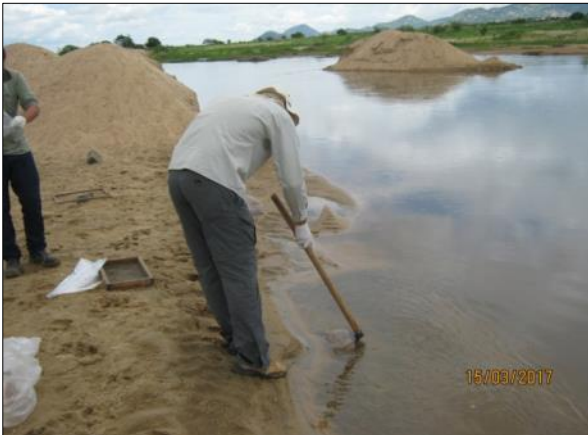
Foto 115. Coleta de sedimentos para análise granulométrica (15/03/2017).
