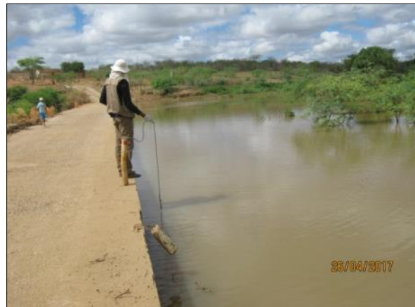
Foto 26. Obtenção de dados físico-químicos utilizando a sonda multiparâmetros (26/04/2017).
