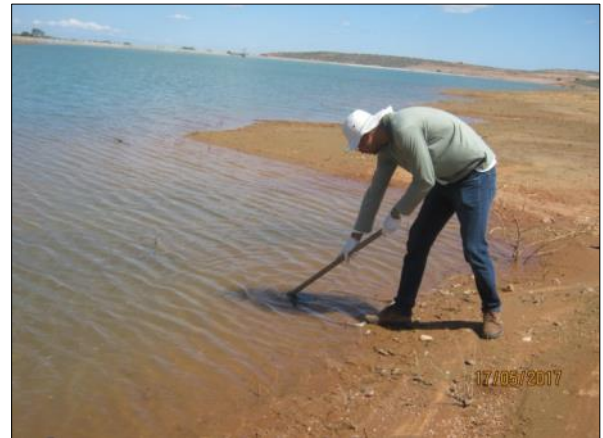
Foto 14. Coleta de sedimentos para ensaio granulométrico (17/05/2017).
