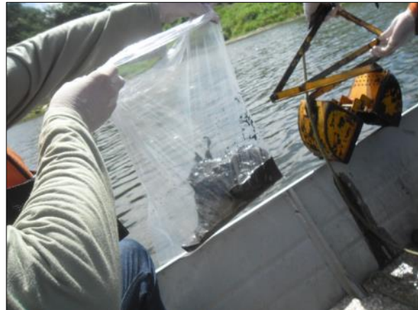
Foto 104. Coleta de sedimentos em profundidade com o auxílio da draga de Petersen (04/04/2017).
