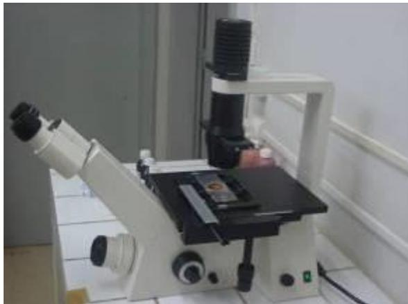
Figura 2: Microscópio invertido utilizado para análise quantitativa da comunidade fitoplanctônica.
