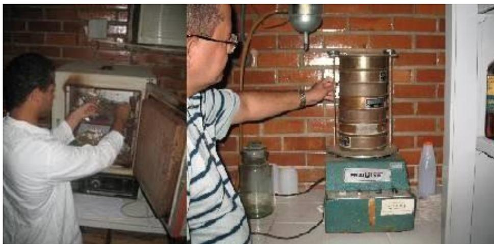
Figura 9: Secagem do sedimento em estufa e separação das frações granulométricas no Rotape.
