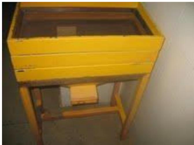
Figura 5: Peneiras granulométricas utilizadas na lavagem dos sedimentos.
