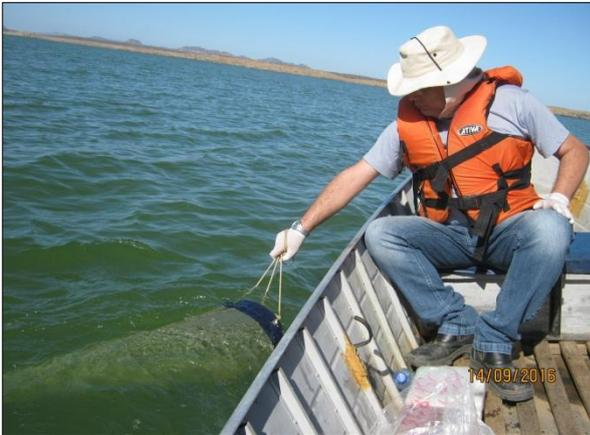
Foto 112. Coleta de amostra de água para ensaio de zooplâncton (14/09/2016).
