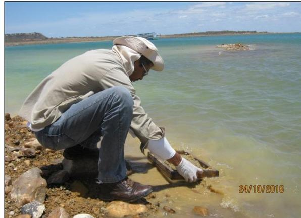
Foto 49. Coleta de sedimentos para ensaio de zoobentos pelo método da peneira (24/10/2016).
