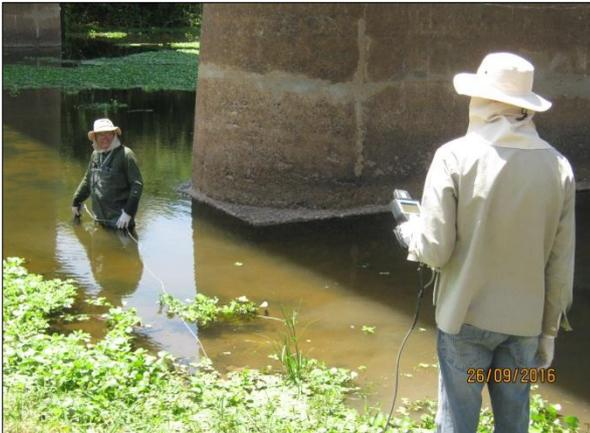
Foto 104. Coleta de dados físico-químicos utilizando a sonda multiparâmetros (26/09/2016).
