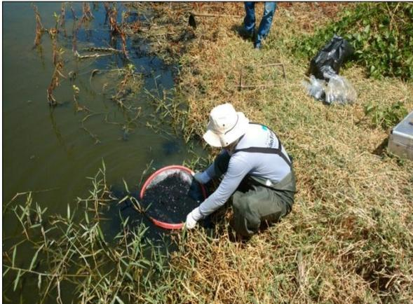
Foto 80. Coleta de sedimentos pelo método da peneira para ensaio de zoobentos (30/08/2016).
