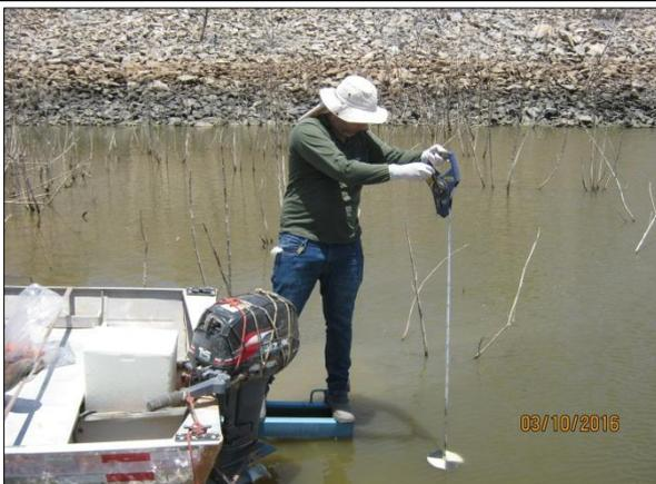
Foto 34. Avaliação da transparência da água utilizando o disco de Secchi (03/10/2016).
