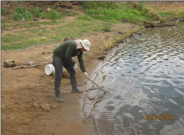
Foto 14. Coleta de sedimentos para ensaio de zoobentos utilizando o método do quadrado (04/10/2016).
