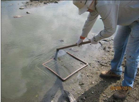
Foto 90. Coleta de sedimentos pelo método do quadrado para ensaio de zoobentos (28/09/2016).
