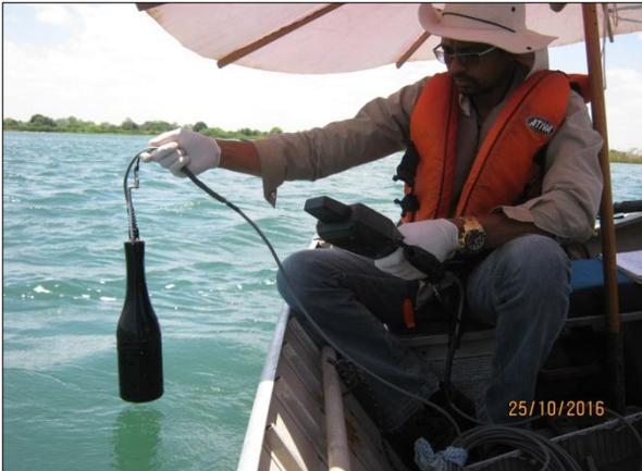
Foto 52. Coleta de dados físico-químicos utilizando a sonda multiparâmetros (25/10/2016).
