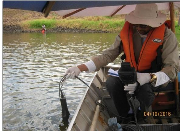
Foto 15. Coleta de dados físico-químicos utilizando a sonda multiparâmetros (04/10/2016).
