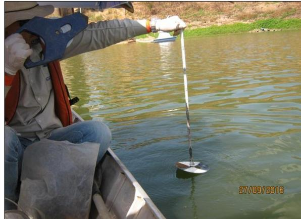
Foto 93. Avaliação da transparência da água utilizando o disco de Secchi (27/09/2016).
