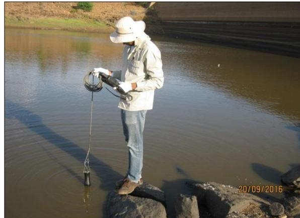
Foto 57. Coleta de dados físico-químicos utilizando a sonda multiparâmetros (20/09/2016).
