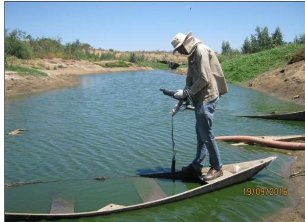
Foto 117. Coleta de dados físico-químicos utilizando a sonda multiparâmetros (19/09/2016).
