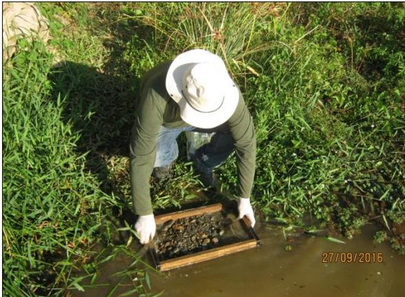
Foto 94. Coleta de sedimentos pelo método da peneira para ensaio de zoobentos (27/09/2016).
