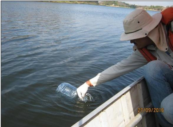
Foto 98. Coleta de amostra de água para ensaio de cianobactérias (27/09/2016).
