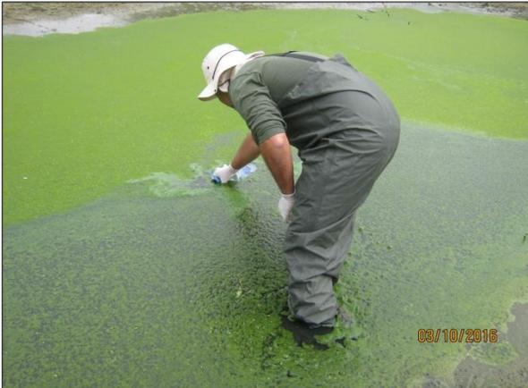
Foto 32. Coleta de amostra de água para ensaio de cianobactérias (03/10/2016).
