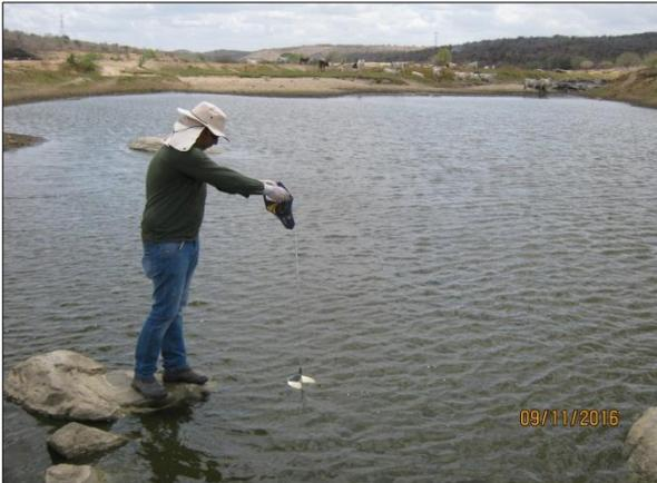
Foto 28. Avaliação da transparência da água utilizando o disco de Secchi (09/11/2016).
