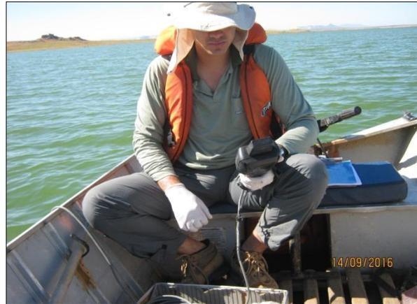
Foto 113. Coleta de dados físico-químicos utilizando a sonda multiparâmetros (14/09/2016).
