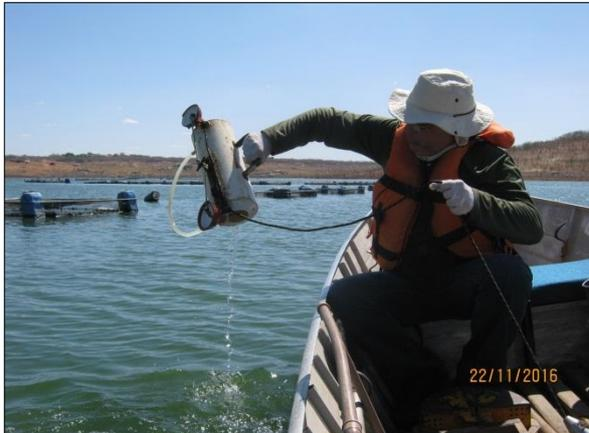
Foto 70. Coleta de amostra de água em profundidade com o auxílio da garrafa de van Dorn (22/11/2016).
