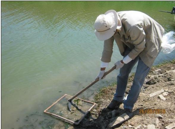
Foto 102. Coleta de sedimentos pelo método do quadrado para ensaio de zoobentos (26/09/2016).
