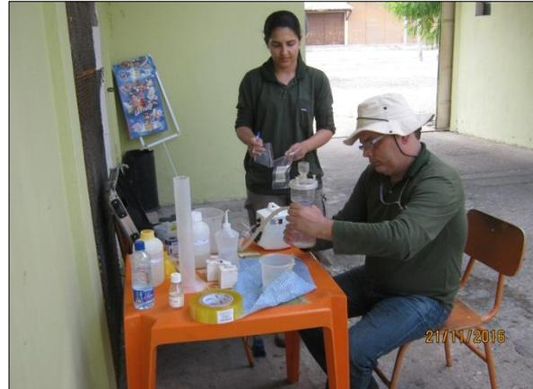
Foto 4. Filtração para determinação de clorofila-a e feofitina-a (21/11/2016).
