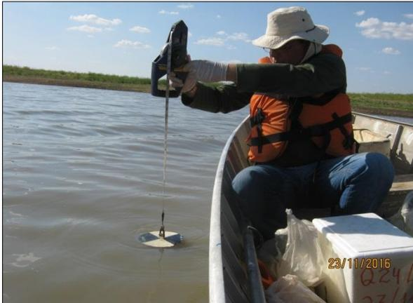
Foto 66. Avaliação da transparência da água utilizando o disco de Secchi (23/11/2016).
