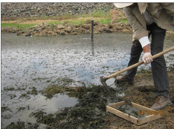
Foto 18. Coleta de sedimentos para ensaio de zoobentos utilizando o método da peneira (04/10/2016).
