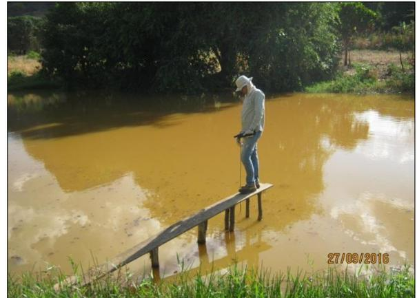
Foto 95. Coleta de dados físico-químicos utilizando a sonda multiparâmetros (27/09/2016).
