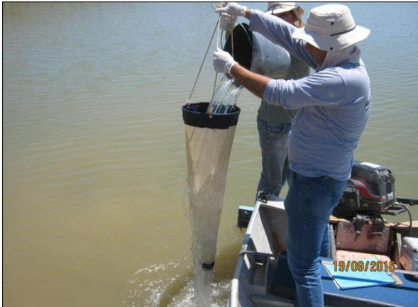
Foto 118. Coleta de amostra de água para ensaio de zooplâncton (19/09/2016).
