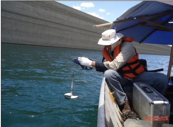
Foto 86. Avaliação da transparência da água utilizando o disco de Secchi (29/08/2016).
