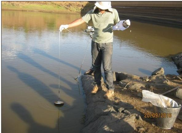
Foto 56. Avaliação da transparência da água utilizando o disco de Secchi (20/09/2016).
