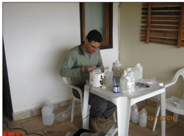
Foto 5. Filtração da amostra para determinação de metais dissolvidos (08/11/2016).
