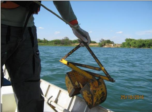
Foto 122. Coleta de sedimentos em profundidade com o auxílio da draga de Petersen (25/10/2016).
