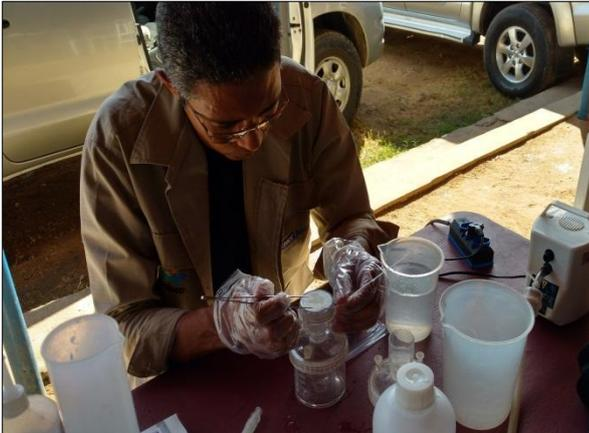
Foto 3. Filtração para determinação de clorofila-a e feofitina-a (29/08/2016).
