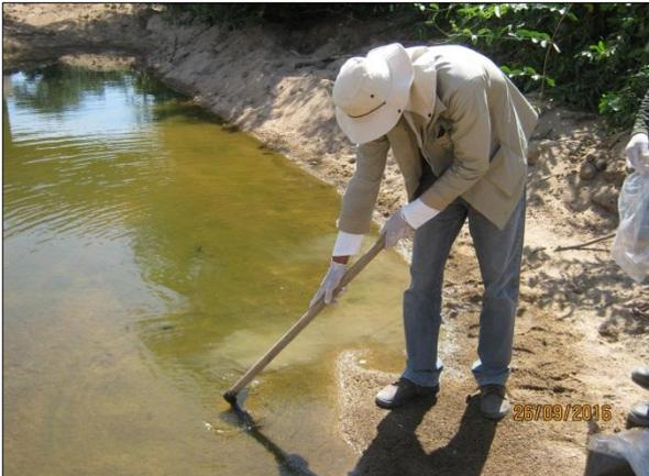
Foto 100. Coleta de sedimentos para ensaio granulométrico (26/09/2016).
