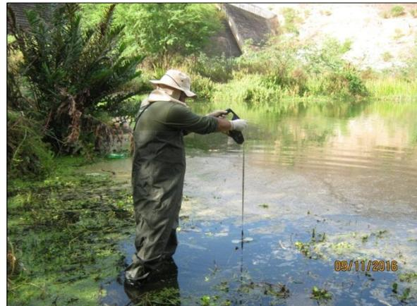
Foto 31. Avaliação da transparência da água utilizando o disco de Secchi (11/05/2016).
