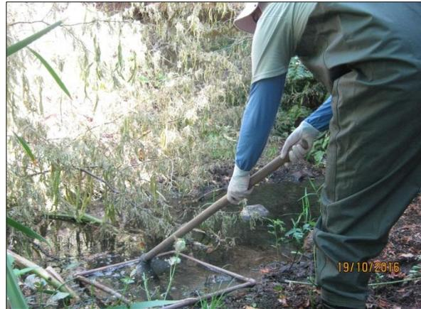
Foto 43. Coleta de sedimentos para ensaio de zoobentos pelo método do quadrado (19/10/2016).
