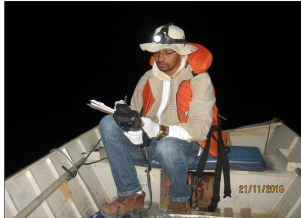
Foto 73. Obtenção noturna de dados físico-químicos utilizando a sonda multiparâmetros (21/11/2016).
