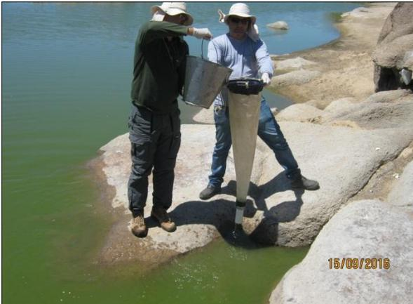
Foto 108. Coleta de amostra de água para ensaio de zooplâncton (14/09/2016).
