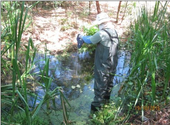
Foto 42. Avaliação da transparência da água utilizando o disco de Secchi (19/10/2016).
