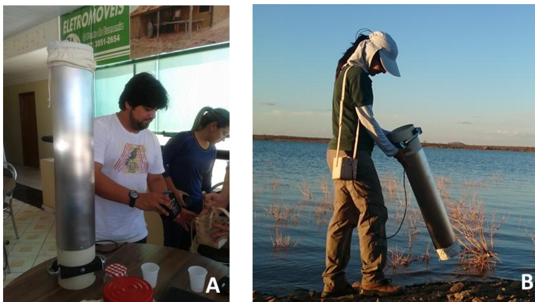
Figura 2. A-B. Aspirador Entomológico elétrico, com auxílio de bateria 12V, utilizado na busca ativa da fauna de mosquitos potencialmente vetores de doenças na ADA do empreendimento.
