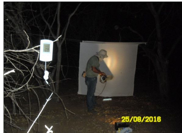
Foto 14. Coleta noturna de insetos adultos utilizando a armadilha Shannon com adaptações e coleta de dados microclimáticos (Ago/2016).
